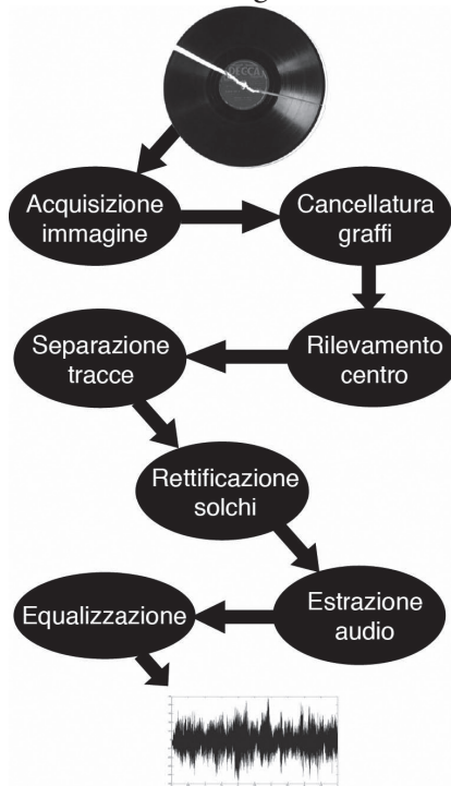
FIG. 16 - Schema logico del software in grado di ricostruire l'audio dalla fotografia dei vecchi dischi a 78 giri.
