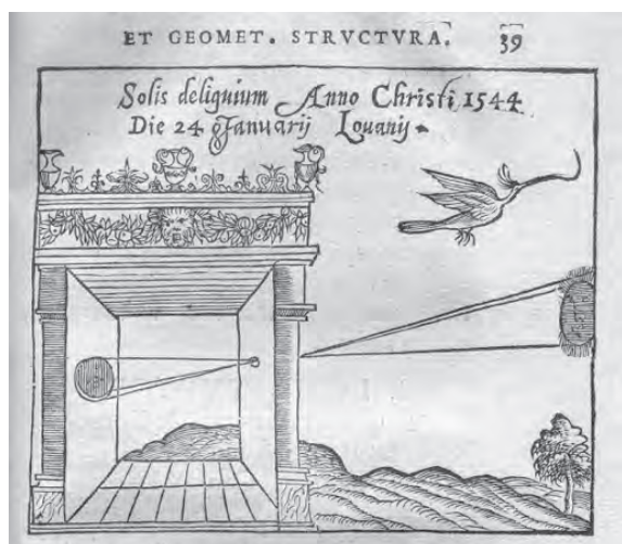
Fig. 15 Scritto nel 1545 da Gemma Frisius, il De Radio Astronomico et Geometrico contiene la prima illustrazione nota di una camera oscura.
