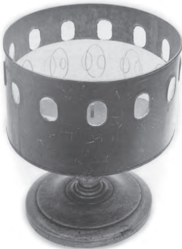
Fig. 25 Lo zootropio di Maxwell, costruito nel 1868 e conservato al Cavendish Laboratory di Cambridge. Lo strumento permette di mostrare la dinamica degli anelli di vortice di Helmholtz (Harman, 1995, vol. 2, tavola XIII, p. 446)
