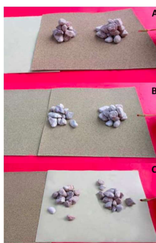
Fig. 6 - Situazione A: lo sfregamento tra le superfici lisce dei due fogli; Situazione B: il contatto tra una superficie liscia e una ruvida; Situazione C: lo sfregamento tra due superfici ruvide, che provoca un terremoto.
