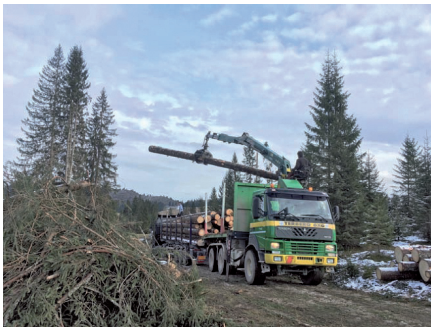
FIG. 4 - Un autoarticolato capace del trasporto di grandi volumi di legname impone che le vie di accesso e di esbosco consentano manovre rapide e in piena sicurezza per il mezzo, per chi lo manovra e per le maestranze che collaborano al carico dei fusti.
