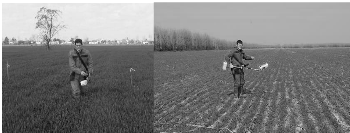
Fig. 5. Misurazioni con spettroradiometro attivo NDVI “Greenseeker”, si riportano le immagini per fornire indicazioni relative alle modalità di utilizzo e all'ingombro dell'attrezzatura.
