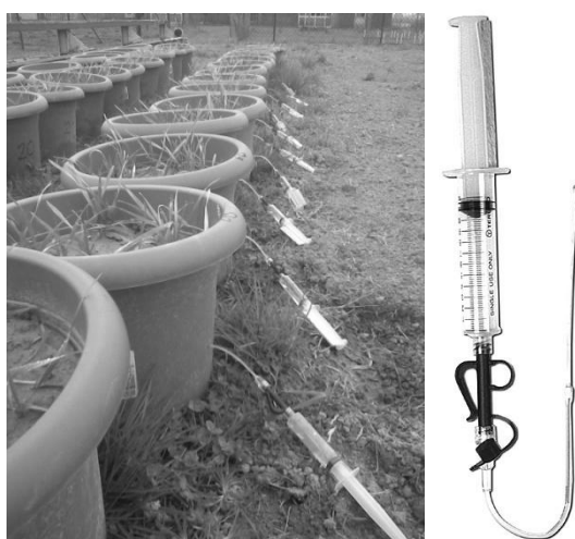
Fig. 26: sistema di campionamento della soluzione circolante allestito nei vasi.
