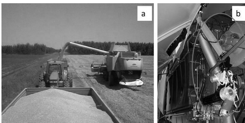
Fig. 16: scarico della produzione delle parcelle in singoli rimorchi per validare il dato del sistema di rilevamento della resa (a). Spettrometro NIR installato all'interno della mietitrebbia (b), si notino i tubi di by-pass installati sul sollevatore del prodotto, foto dal sito del costruttore ( www.grainit.it )
