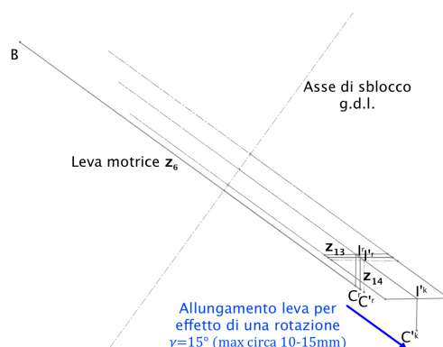
Figura 7.21: Cambiamento del meccanismo bidimensionale per effetto di una rotazione positiva dell'angolo \gamma in due posizioni diverse del meccanismo bidimensionale (estensione massima e flessione intermedia) in vista laterale (piano di moto).
