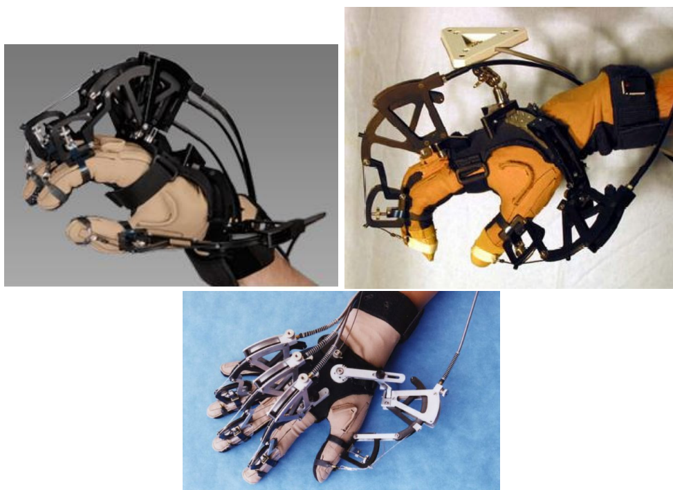
Figura 4.23: Immagini del sistema CyberGrasp. [59]
