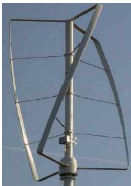
Figura 1.5: Esempio di aerogeneratore con rotore ad asse verticale
