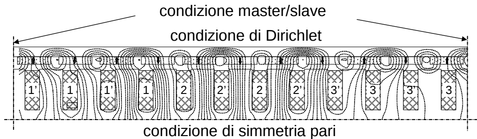
Figura 4.3: Modello rettificato 2D con condizioni al contorno per l'analisi FEM (sezione cilindrica \phi -z in corrispondenza del raggio medio R_m )
