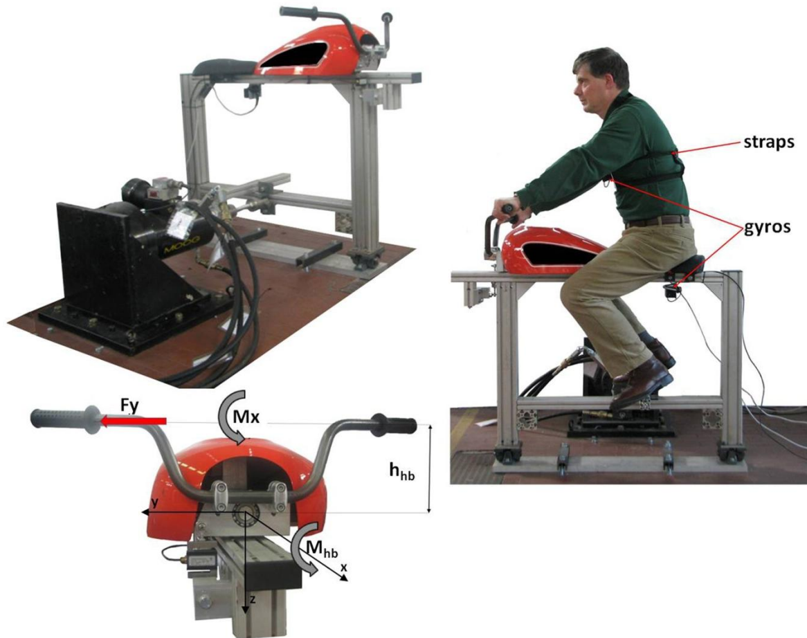
Fig. 2.2 Apparato sperimentale per i test con moto di rollio imposto
