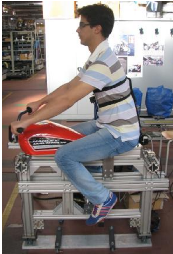
Fig. 5.2 Prova di rollio con misurazione delle forze di reazione.
