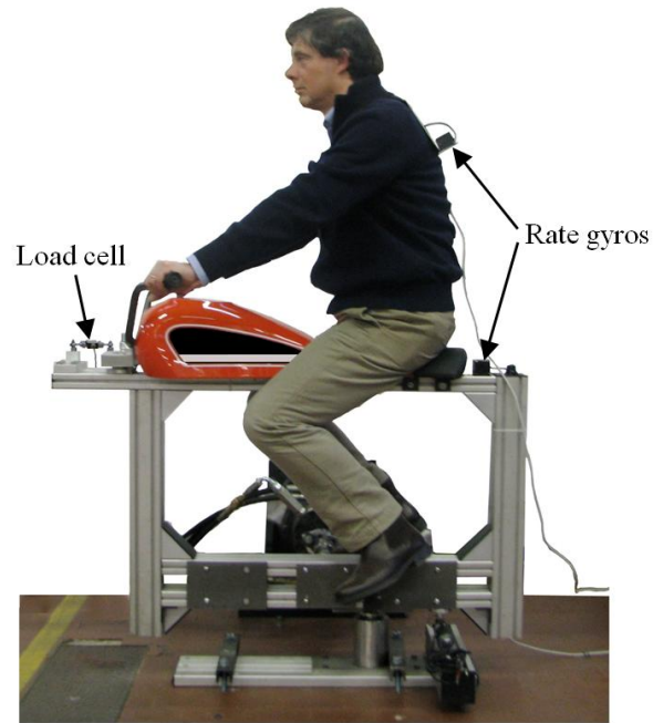
Fig. 2.6 Apparato sperimentale per i test a moto imposto di imbardata con strumentazione
