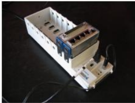
Fig. 2.12 Il sistema di acquisizione National Instruments
