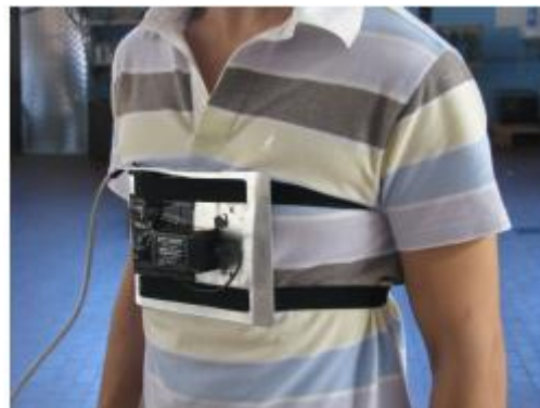
Fig. 2.3 Posizionamento del girometro sul petto del pilota
