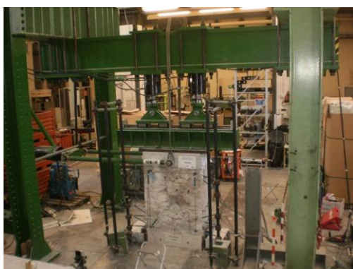
Figura 3.34 Set-up della struttura per i test a compressione e taglio a) e postazione di controllo b)
