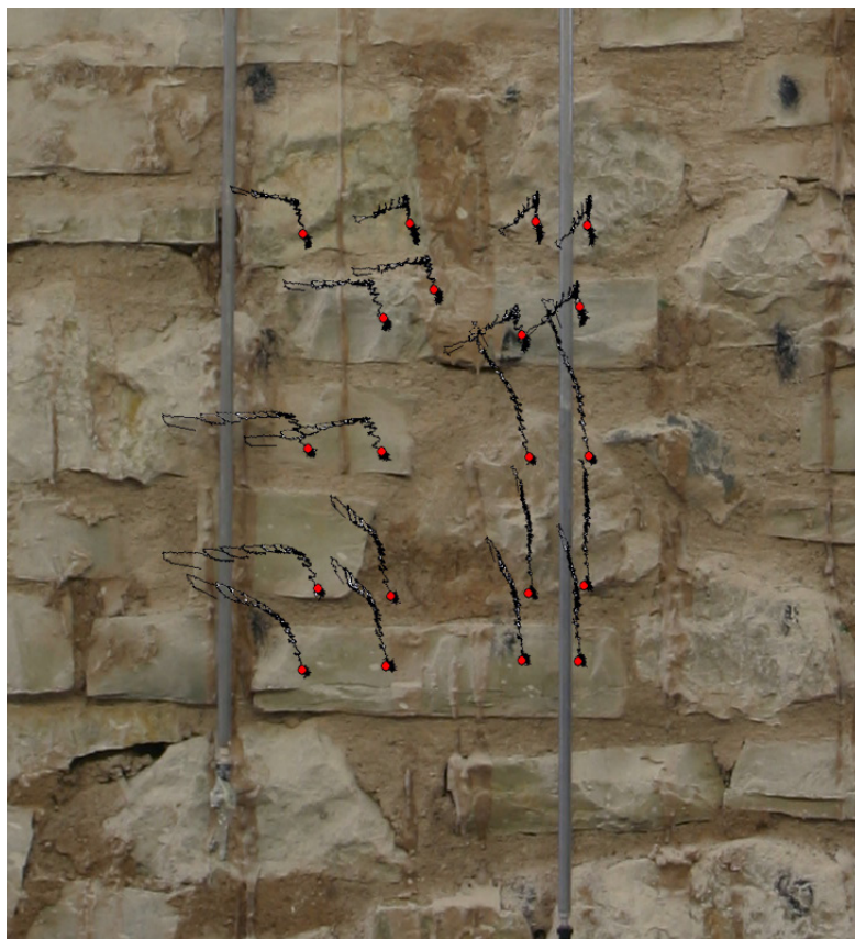
Figura 4.30 Rappresentazione degli spostamenti rilevati con l'acquisizione ottica nella prova DFJ-P2 su muro A6.
