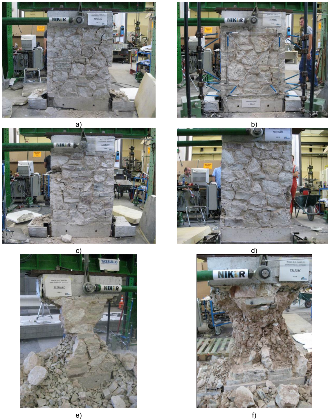
Figura 5.7 Pannello C1 fessurazione a taglio (a), pannello C2 rottura a taglio e a compressione (b), pannello C4 rottura a flessione (c), pannello E4 rottura a flessione (d), pannello C1 separazione dei paramenti a causa di instabilità (e), pannello C8 paramento interno iniettato (f).
