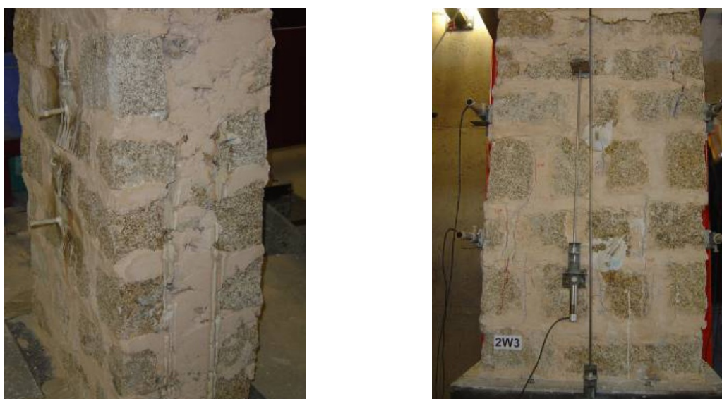
Figura 2.79 Pannello murario a tre paramenti con i connettori i GFRP e durante il test a compressione. (Oliveira et al., 2006)
