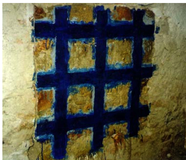
Figura 2.77 a) Pannello a Ponte Postignano riparato con la tecnica di iniezione di malta di calce; b) Pannello per prova di compressione diagonale rinforzato con FRP. (Corradi et al., 2002)
