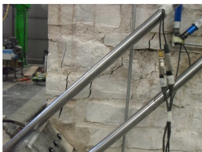
Figura 4.38 Rappresentazione dei risultati delle prove diagonali in laboratorio con il confronto tra la forza diagonale applicata e la resistenza a taglio.
