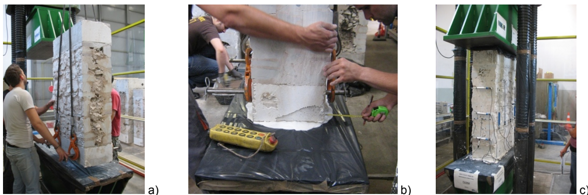
Figura 3.25 Preparazione della prova di compressione, posizionamento del pannello (a), centraggio (b) e strumentazione (c).
