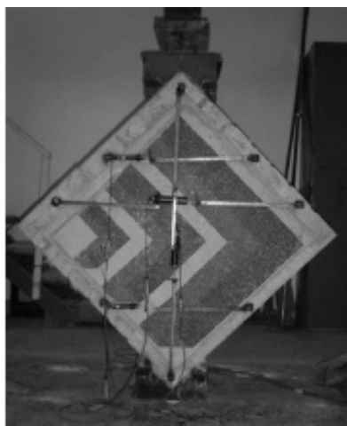
Figura 2.37 Schema di prova di compressione diagonale in laboratorio (a) (Vintzileou et al. 2007) e in sito (b) (Corradi et al., 2002).
