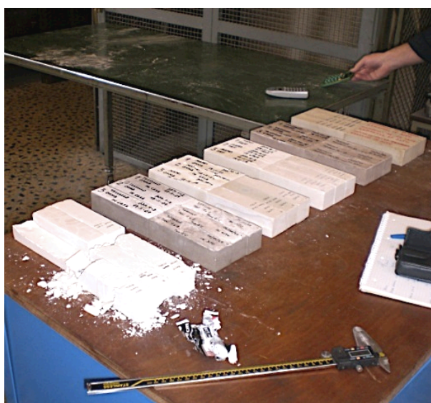
Figura 5.13 Prismi di miscela prima dei test, in primo piano la miscela F deteriorata dal gelo.
