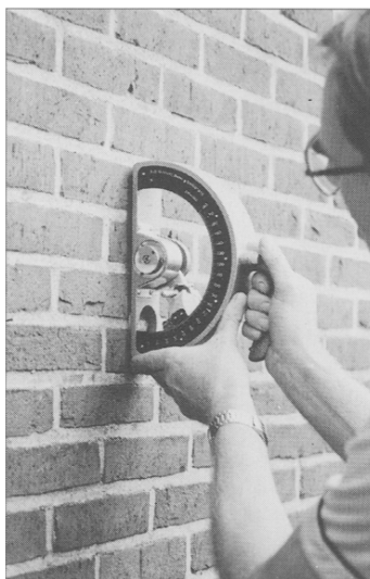
Figura 2.21 Misura della durezza superficiale con sclerometro a pendolo con modifiche di Van Der Klugt. (Rilem TC127.MS-D.7, 1997)
