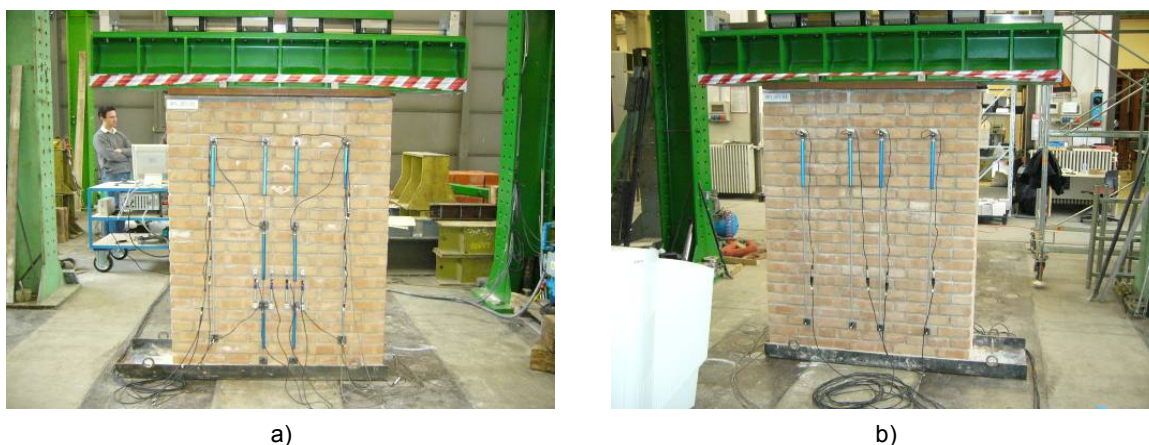
Figura 4.5 Disposizione dei sensori del sistema del laboratorio sul campione: a) lato esecuzione test di martinetto piatto; b) lato opposto.
