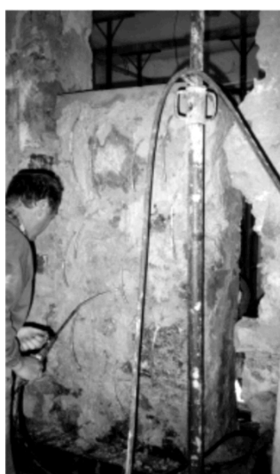
Figura 2.77 a) Pannello a Ponte Postignano riparato con la tecnica di iniezione di malta di calce; b) Pannello per prova di compressione diagonale rinforzato con FRP. (Corradi et al., 2002)
