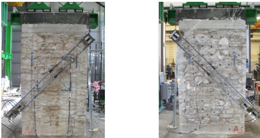
Figura 4.35 Disposizione della strumentazione necessaria all'esecuzione della prova diagonale.
