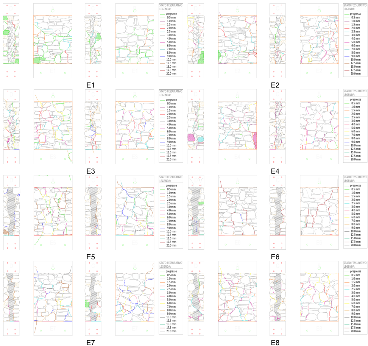
Figura A.26 Quadri fessurativi delle prove di compressione sui muri E.
