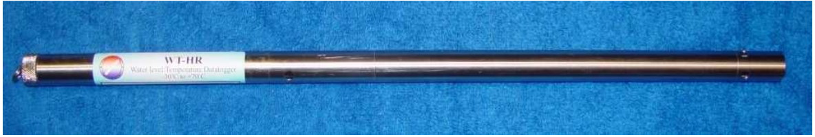
Figura 4.9: La sonda capacitativa del piezometro idraulico.
