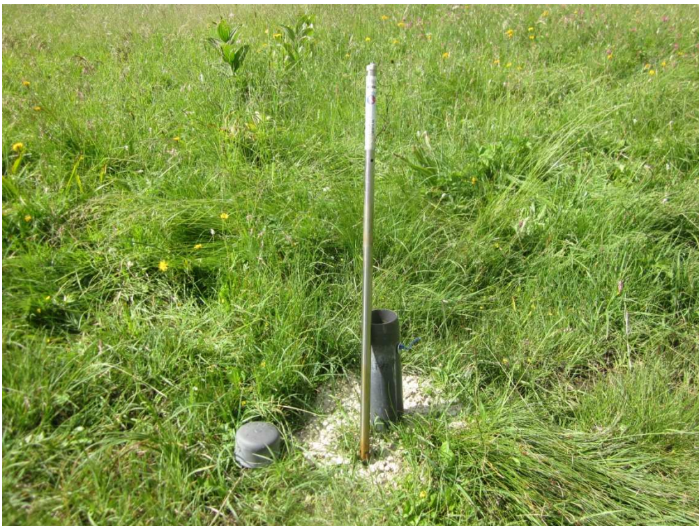
Figura 4.10: Tubo piezometrico e sonda capacitativa.
