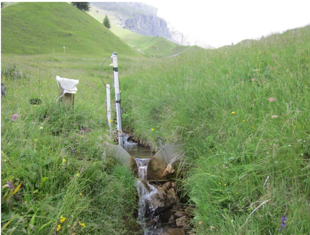
Figura 4.2: Lo stramazzo installato sul Rio Ponte, e l'alloggiamento del misuratore di livello.
