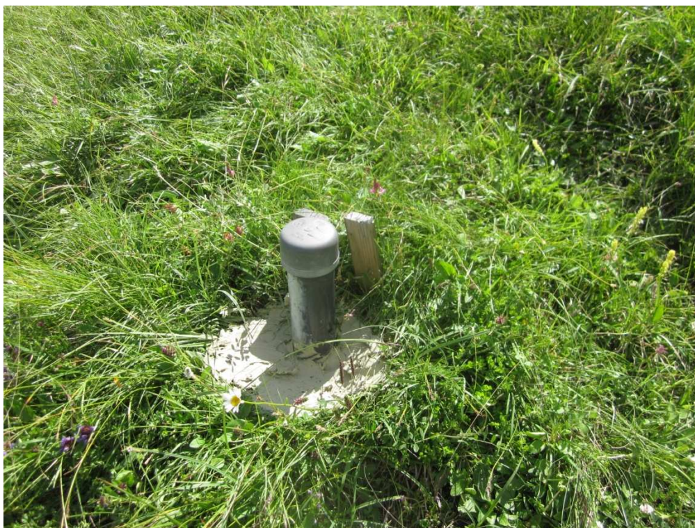
Figura 4.8: Il piezometro idraulico in cui è inserita la sonda capacitiva per la misura del livello di falda.
