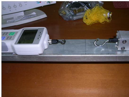
Figura 5. Dinamometro utilizzato per la misurazione della resistenza alla rottura dei filamenti e particolare del banco dinamometrico.
