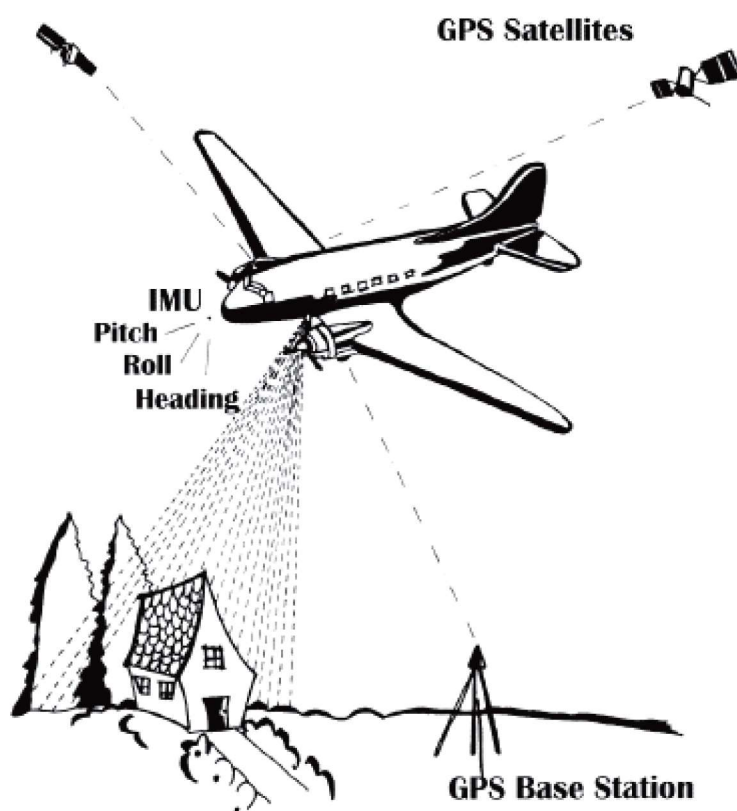
Fig. 2. 1 Componenti di un sistema LiDAR. Da HANUS, 2012.
