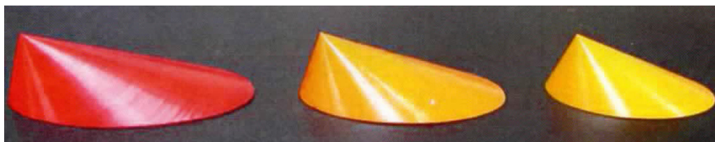
Figura 3.4: Conoidi in nylon per la riproduzione in scala di modello, da applicare rispettivamente su piani inclinati di 30 gradi (rosso), 27 gradi (arancio), e 24 gradi (giallo) rispetto all'orizzontale.
