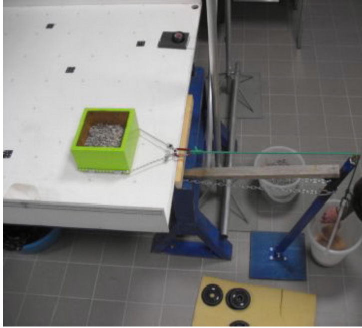
Figura 3.7: Apparato sperimentale per la determinazione dell'angolo d'attrito tra il materiale e la canaletta.
