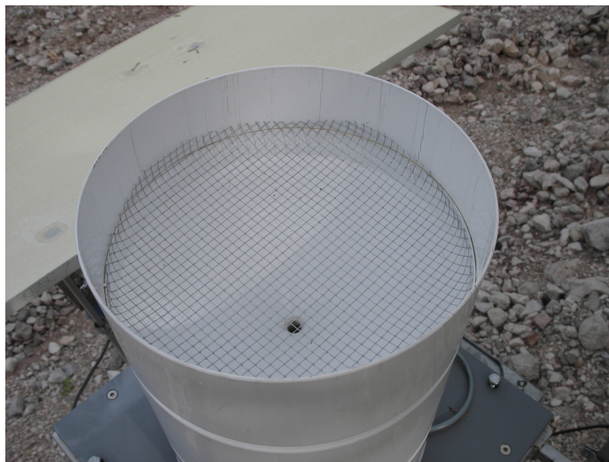
Figura 9.2: Le retine a maglie inserite nei 2 punti critici dello strumento hanno la funzione di limitare fortemente l'occlusione dovuta ad impurità.
