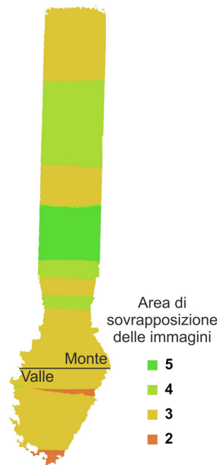
Figura 5.23: Sovrapposizione delle immagini sulla canaletta sperimentale. La configurazione rimane inalterata rispetto al Test 1.
