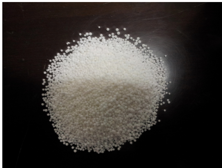
Figura 3.13: Materiale in PVC bianco per favorire la restituzione fotogrammetrica.
