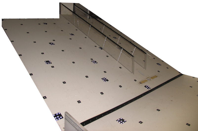
Figura 4.2: Piano di monte con sponde laterali di contenimento. I marker retroriflettenti sono utili per la calibrazione e per il settaggio della scala. I Control Point distribuiti sulla superficie definiscono tridimensionalmente entrambi i piani.
