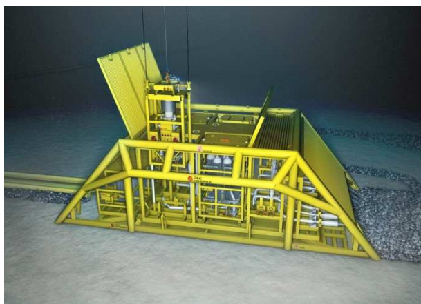
Fig.0.32 - Immagine di un tipico Subsea Manifold
