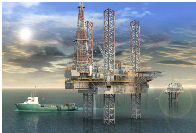
Fig.0.28 - Immagine di una piattaforma fissa tipo Jack-up
