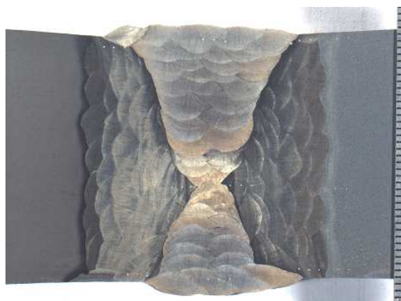
Fig.1.3 – Macrografia: lato SX MB 461TS a DX lato MB 12TS Attacco Acido Ossalico + Vilella + Persolfato di Ammonio
