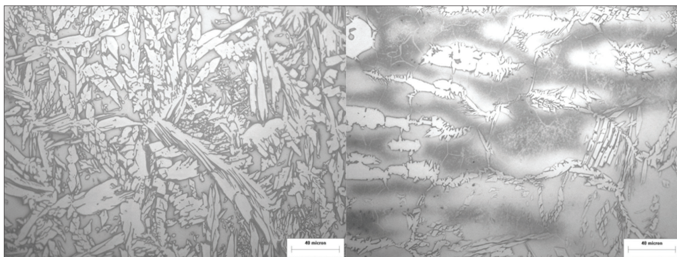
Figura 3 - Tallone 29316 - esame micrografico ottico zona saldatura di radice; zona fusa (SX) e zona termicamente alterata (DX); attacco elettrolitico con NaOH; ingrandimento x500
