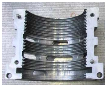
Fig.0.26 - Immagine di dettaglio di una tenuta a labirinto di un rotore De Pretto
