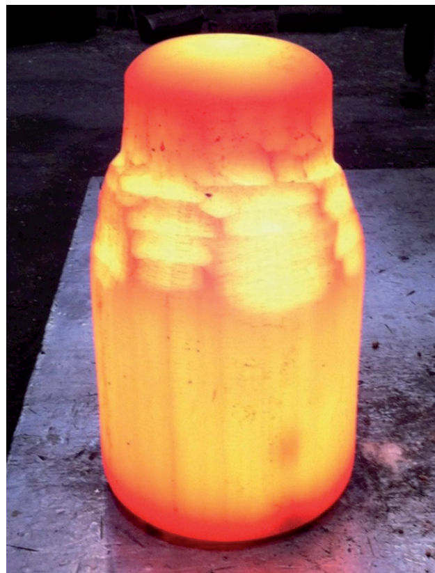
Fig.5 - Foto del pezzo dopo stiratura, alla fine della prima calda.
