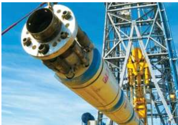
Fig.0.34 - Immagine di una sezione di sistema Riser
