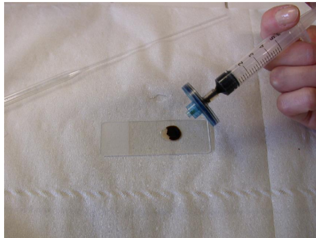
Figura 6 Preparazione del campione per la colorazione con rosso di Alizarina. Una goccia di LS viene mescolata con il colorante filtrato per eliminare i precipitati della soluzione madre
