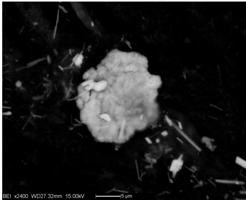
Figura 17. Foto al SEM di cristalli di BCP e piccoli CPP. Ingrandimento 2400x
