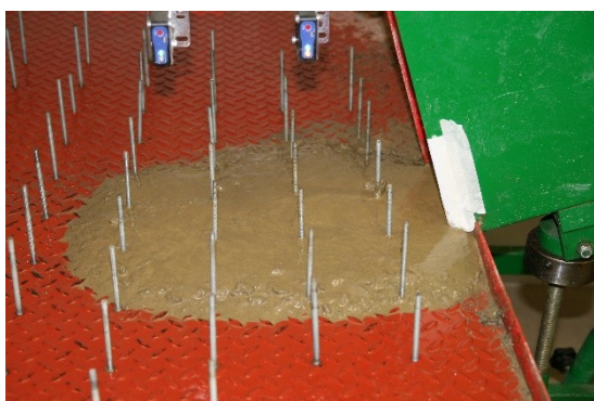
a) Elementi verticali rigidi che simulano la presenza di un bosco d'alto fusto
