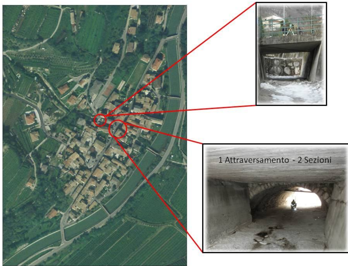
Fig. 3.51: Attraversamenti implementati nella piana di calcolo di FLO-2D.
