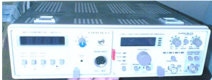
Fig. 5.10: il generatore di segnale utilizzato per la prova.
