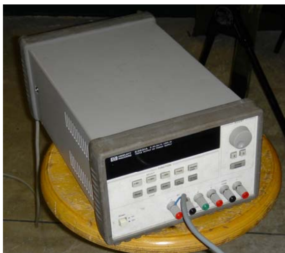
Fig. 6.12: generatore di tensione.
