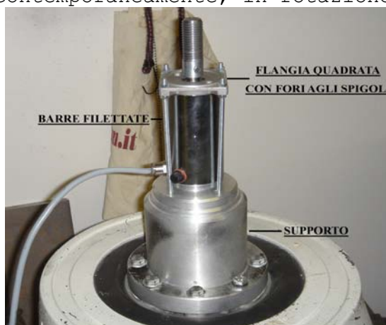
Fig. 8: il banco prova montato sulla testa vibrante dello shaker.
