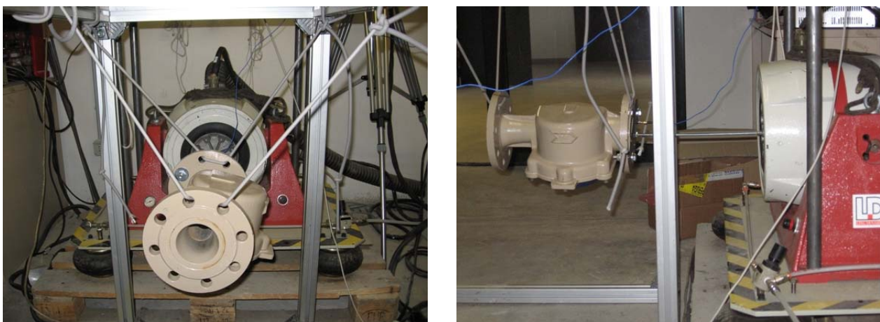
Fig. 4.25: sistema di supporto del misuratore.
