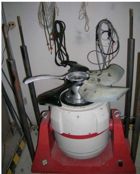
Fig. 6.10: la ventola vincolata rigidamente alla testa dello shaker.
