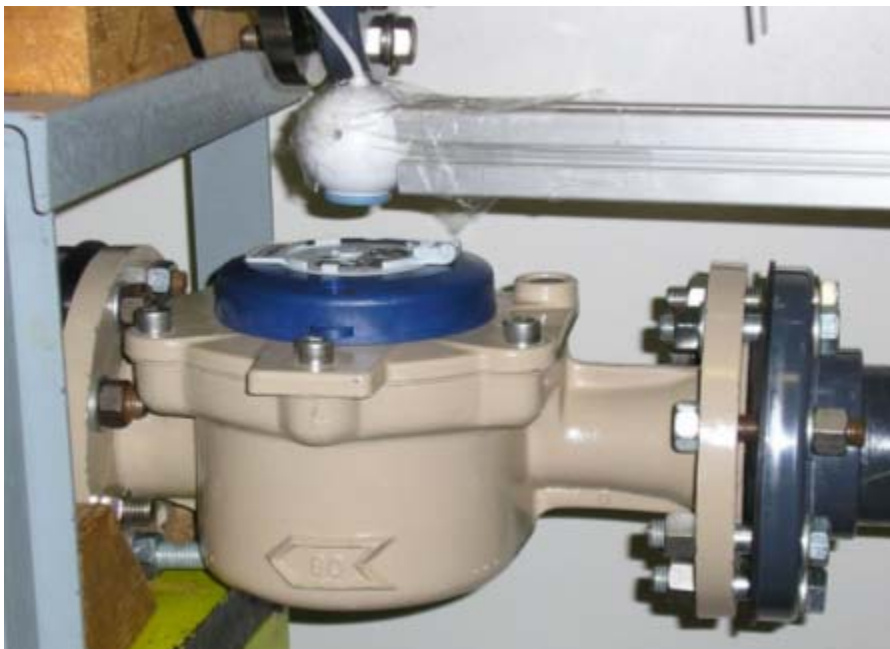
Fig. 4.18: la webcam posizionata sopra al display di lettura del misuratore.
