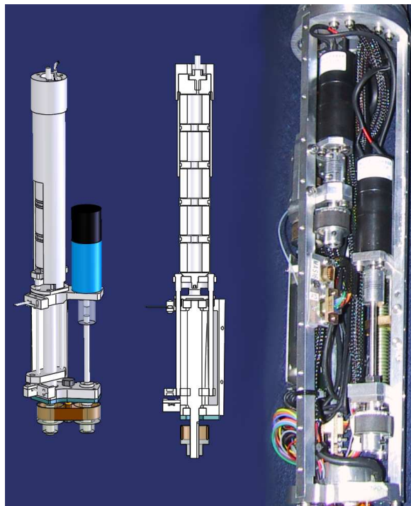
Figura 5.8: Azionamenti dei circuiti oleodinamici. I motori, mediante una trasmissione a cinghia, provocano il movimento lineare di un cursore che produce la compressione del relativo serbatoio costituito da una serie di singole unità comunicanti a soffietti metallici.
