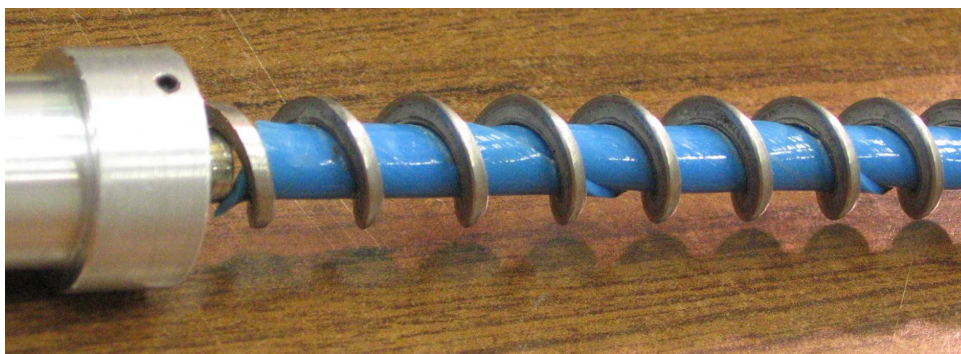
Figura 5.10: Coclea per il trasporto dei detriti internamente al perforatore.
