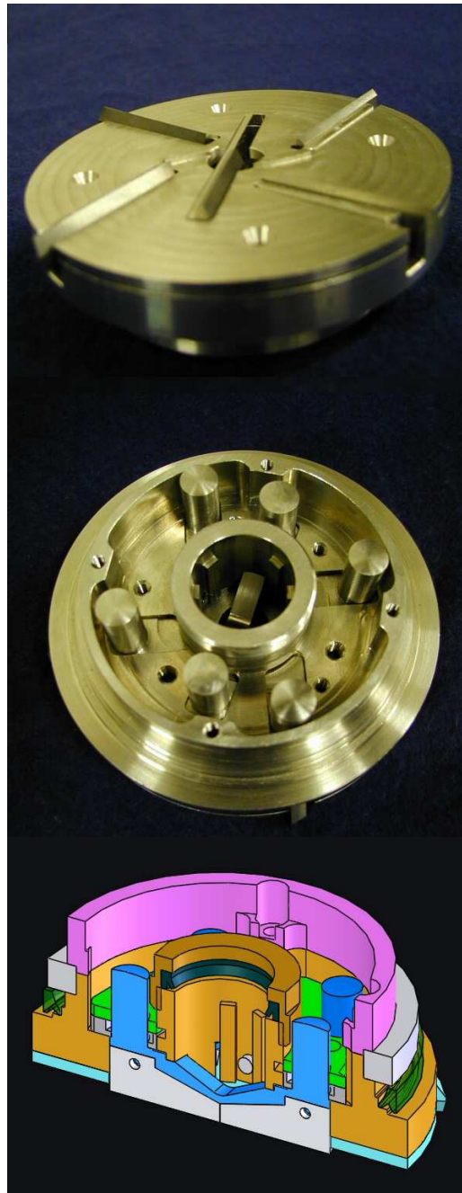
Figura 5.3: Testa di scavo. In alto la distribuzione dei taglienti, al centro in evidenza i perni di impatto per la massa battente, in basso il relativo modello Cad.
