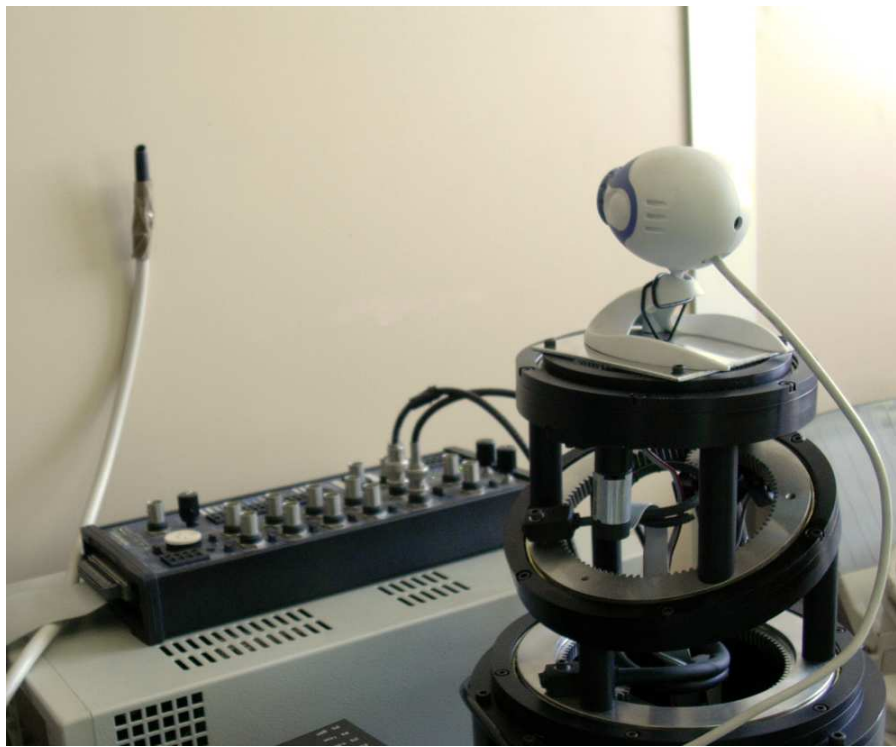
Figura 3.30: Piattaforma con sistema di visione e target.
