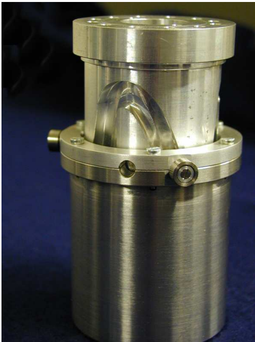
Figura 5.2: Massa battente accoppiata a camma a triplo profilo.
