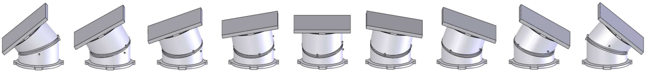
Figura 2.10: Angoli ai giunti in caso di solo beccheggio.
