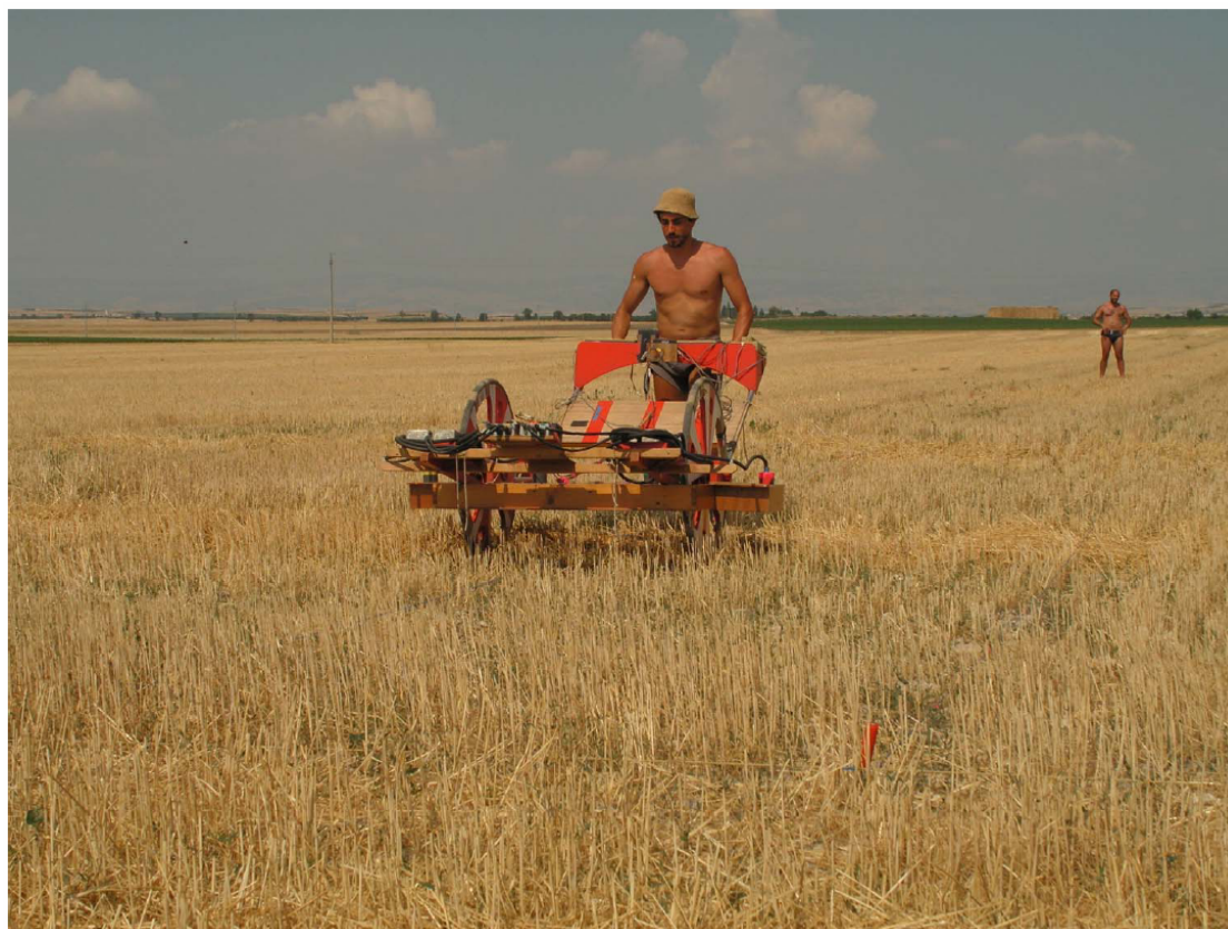
Figura 3.3.2.2: Magnetometri Scintrex Smartmag SM4 in configurazione “quadro-sensor” (4 sensori paralleli al piano campagna distanziati fra loro di 0.5 m) in fase operativa nella Valle del Celone (ripresa Dott. Gallo).
