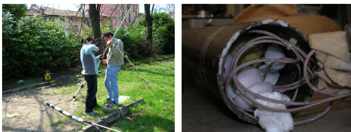
Figura 4.2.1.3: Alcune immagini della preparazione delle antenne prima dell'immersione e dettaglio di un'antenna da foro aperta.
