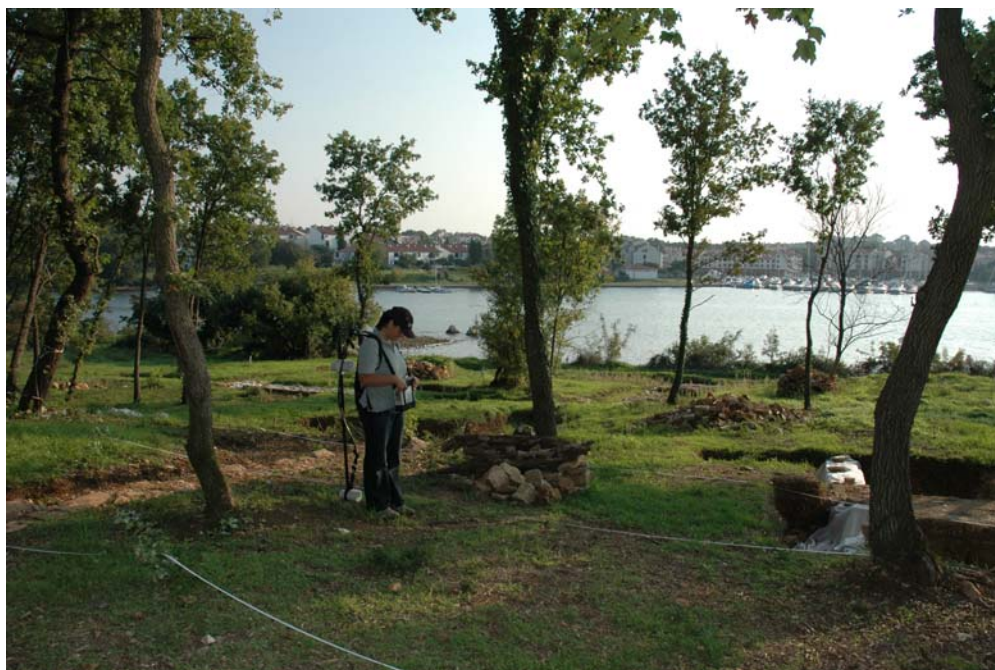
Figura 3.1.2.6: Indagine magnetica con GSM19 in configurazione gradiometrica.
