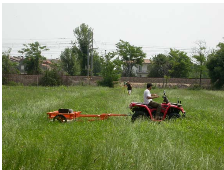
Figura 3.2.2.1: Sistema georadar TerraVision in acquisizione.
