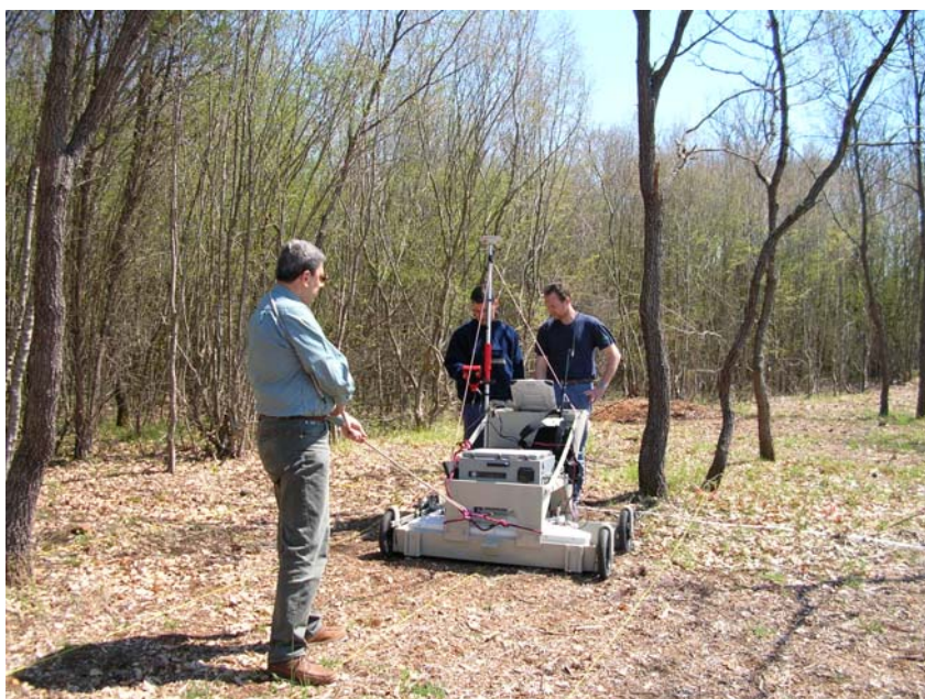
Figura 3.1.2.1: Indagine con TerraVision a 7 antenne e carrello dedicato.
