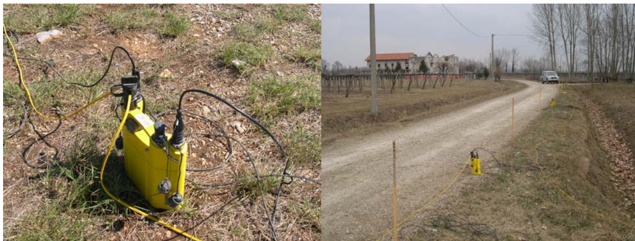
Figura 4.2.1.1: Alcune immagini dell'acquisizione di sismica presso le Torrate di Chions (PN)
