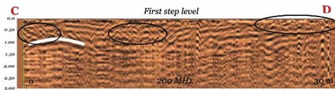
Figura 4.1.7: Radargramma acquisito con antenna da 200MHz su primo gradone.
