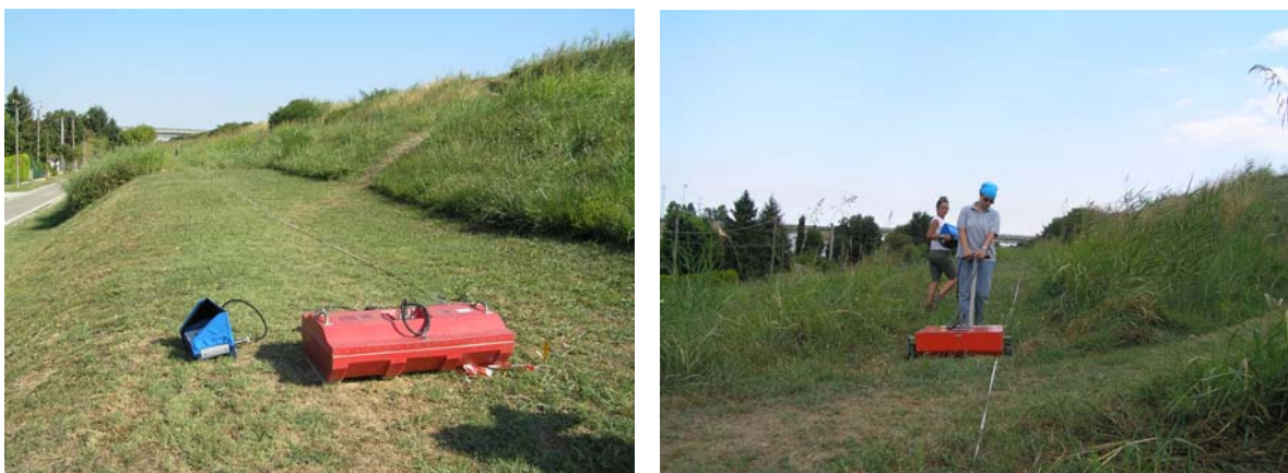
Figura 4.1.3: Antenna GSSI da 100 MHz su primo gradone e antenna da 300 MMz su secondo gradone.
