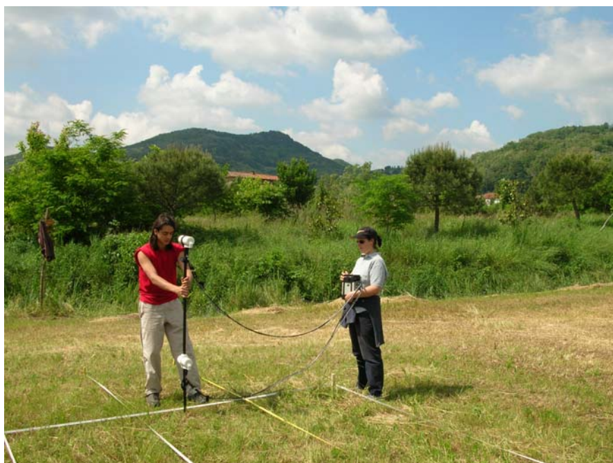
Figura 3.2.2.10: Acquisizione con magnetometro GSM19 effettuata per punti.
