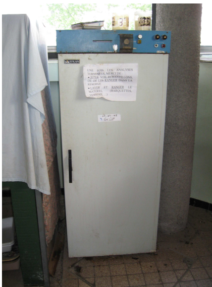
Figura 3.16 Stufa essiccatrice dei campioni, Laboratorio Bron del CNRS (Lyon, Francia).
