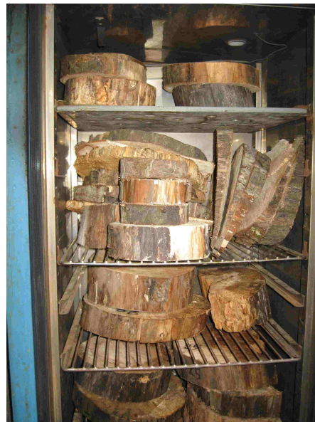
Figura 3.16 Stufa essiccatrice dei campioni, Laboratorio Bron del CNRS (Lyon, Francia).
