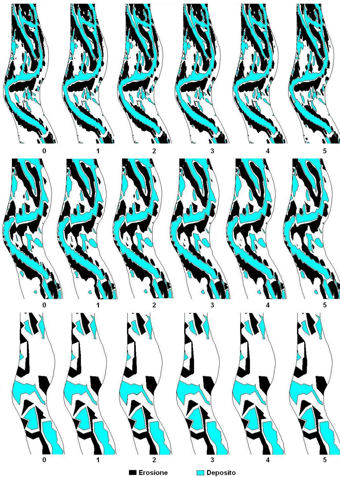
Figura 4.98 Restituzione planimetrica del trasporto solido totale trasversale per le diverse simulazioni utilizzando la griglia 1, 2, 3 (figure a, b, c).
