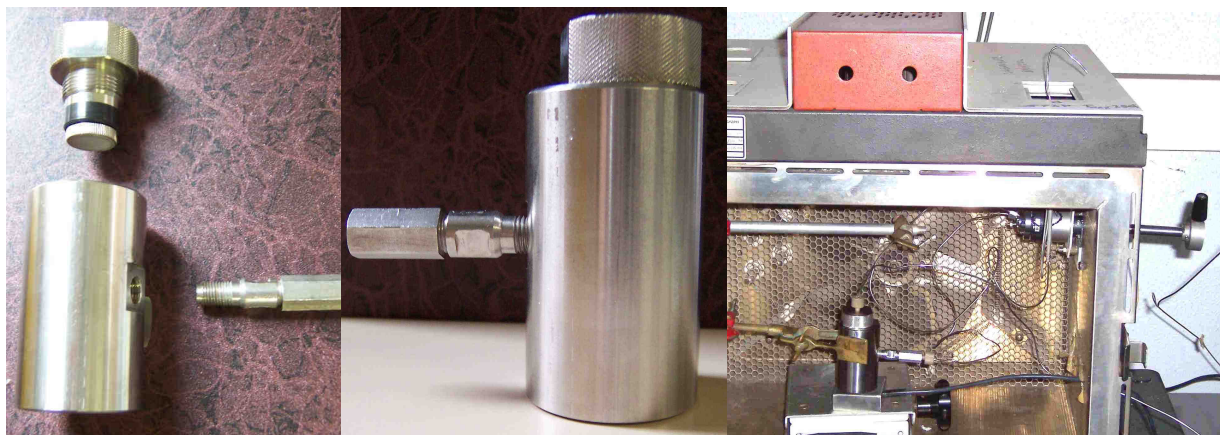
Figura 45: reattore utilizzato nelle reazioni in sc-CO_2 , alloggiato nel forno e collegato alla valvola utilizzata per il campionamento
