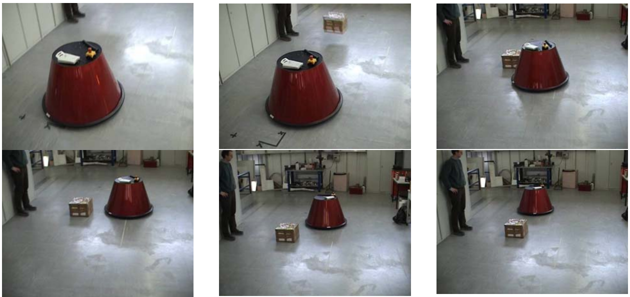
Figura 124: esempio di aggiramento ostacoli
