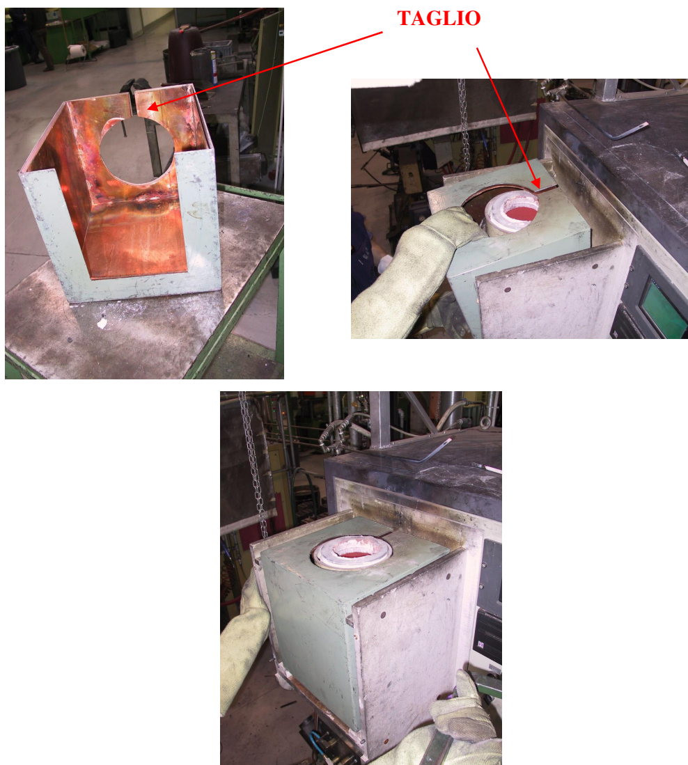
Fig. 3.4-1 - Prototipo dello schermo in rame-acciaio ed installazione. Notare il taglio per evitare circolazione di eccessive correnti indotte.
