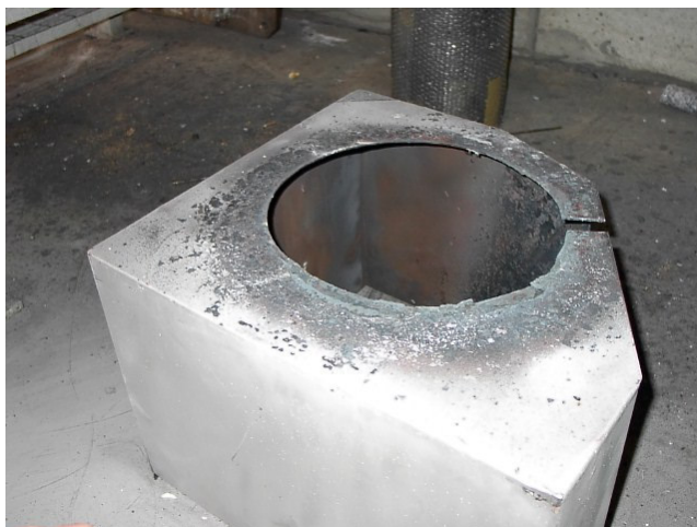
Fig. 3.3-2 - Ossidazione accentuata a seguito dell'eccessivo riscaldamento.
