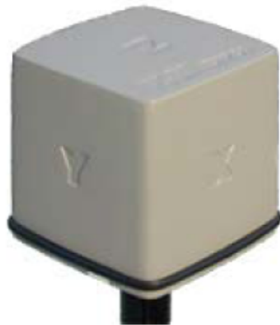
Fig. 3.2-1 Dati tecnici della sonda di campo elettrico e magnetico PMM EHP-50.
