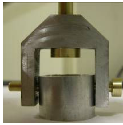
Figura 5.52 - Il dispositivo per il montaggio con inseritovi un bugliolo
