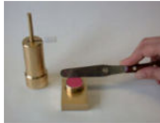
Figura 7.4 -Livellamento del materiale
