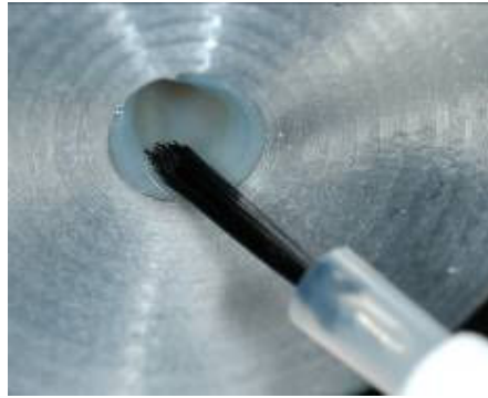
Figura 5.64 - Applicazione del cemento, SINISTRA: sulla cappa, DESTRA: sul composito
