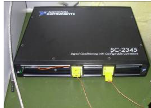
Figura 4.19 - Il sistema di acquisizione dei dati provenienti dalle termocoppie
