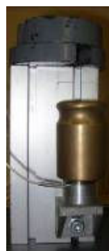
Figura 8.11 - Taratura di una delle celle di carico, secondo step
