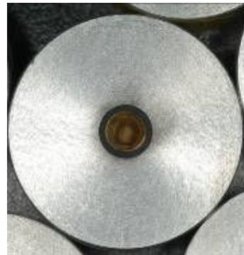
Figura 5.58 - La cappa aurogalvanica dopo la cementazione nel composito
