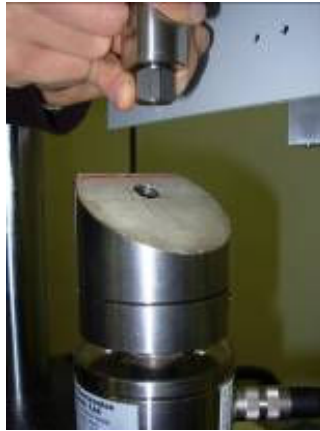
Figura 6.21 - Supporto e punzone nella macchina
