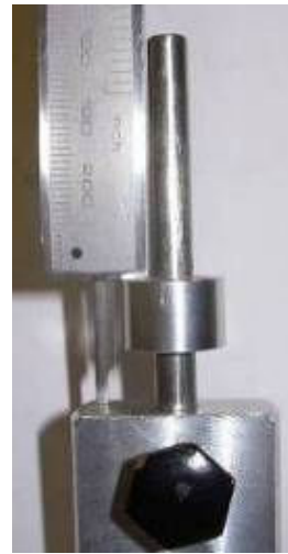
Figura 6.16 - Sistemazione del riferimento per la quota alla "quota richiesta"
