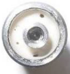
Figura 6.18 - Fixture annegata nella resina, vista dall'alto
