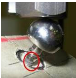
Figura 6.27 - Impianto 2, cricca sulla fixture cerchiata in rosso
