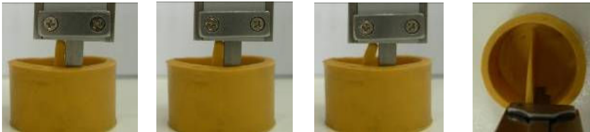
Figura 7.12, Figura 7.13, Figura 7.14 e Figura 7.15 - Misurazione di un campione tramite calibro, effetto della pressione e livello base
