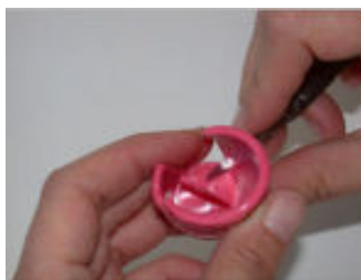
Figura 7.10 - Taglio dei bordi del provino
