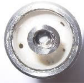
Figura 6.26 - Impianto 1, deformazione della fixture e rottura della vite interna
