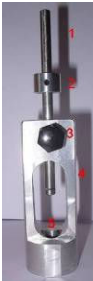
Figure 6.11 e 6.12 - Viste frontale e laterale del dispositivo progettato per il montaggio della fixture ed identificazione delle sue parti con le relative dimensioni
