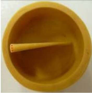
Figura 7.19 - Vista dall'alto di un provino con disegnati in scala tre spot del sensore a triangolazione
