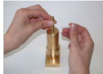
Figura 7.5 - Rimozione del fermo dello stampo
