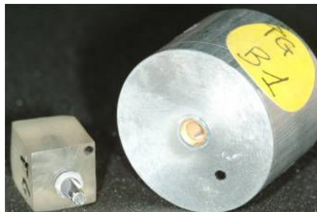
Figura 5.63 - Distacco della cappa dall'abutment
