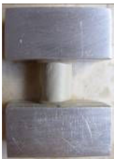
Figura AI.57 - Vista frontale del campione vincolato alle traverse
