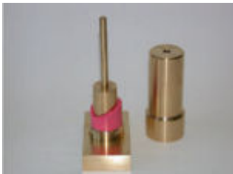
Figura 7.6 e Figura 7.7 - Rimozione dell'involucro esterno (è visibile lo stampo circondato dal materiale polimerizzato)
