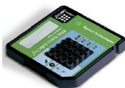
Fig. 3.4. Immagine del RNA 6000 Nano LabChip per l'analisi dell'RNA. Immagine tratta dal sito http://www.home.agilent.com
