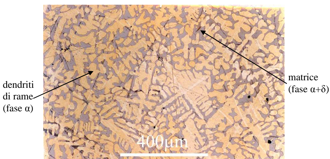
Figura 4.3. Micrografia di un bronzo 80%Cu, 20%Sn ottenuto per fusione (Cochrane, 2002).
