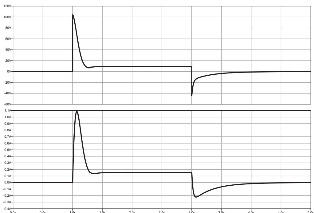
Figura 4.9: Andamento della tensione (grafico superiore) e della corrente (grafico inferiore) nella bobina del freno in seguito ad un comando di eccitazione e di successiva diseccitazione.
