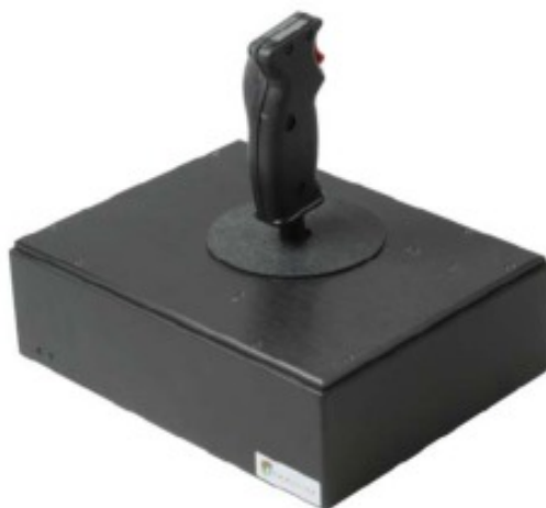
Figura 1.22: Joystick a ritorno di forza Impulse Stick prodotto da Immersion Technologies.
