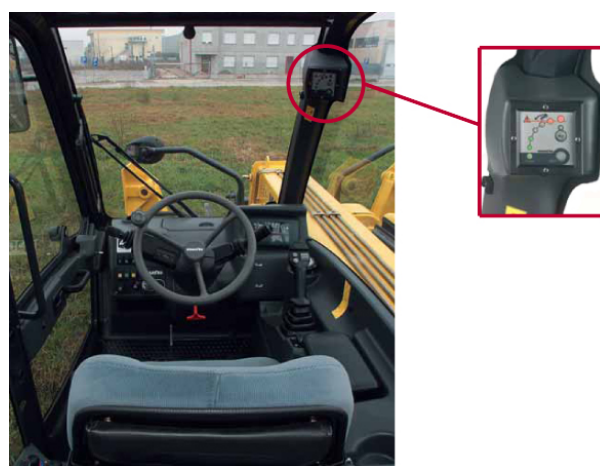
Figura 1.31: Indicatore montato sui sollevatori telescopici Komatsu per indicare l'approssimarsi del limite di instabilità
