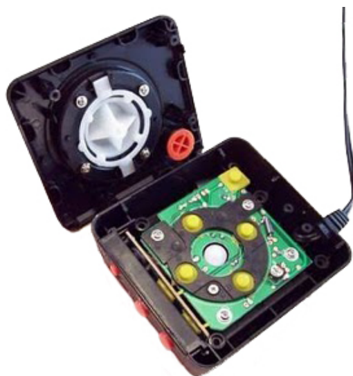
Figura 1.17: Vista interna di un joystick elettronico tipo "Atari", uno dei primi controlli impiegati per il controllo dei videogiochi.
