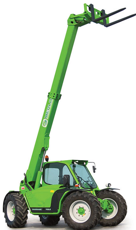
Figura 1.5: Sollevatore telescopico frontale Merlo modello P 32.6 L.
