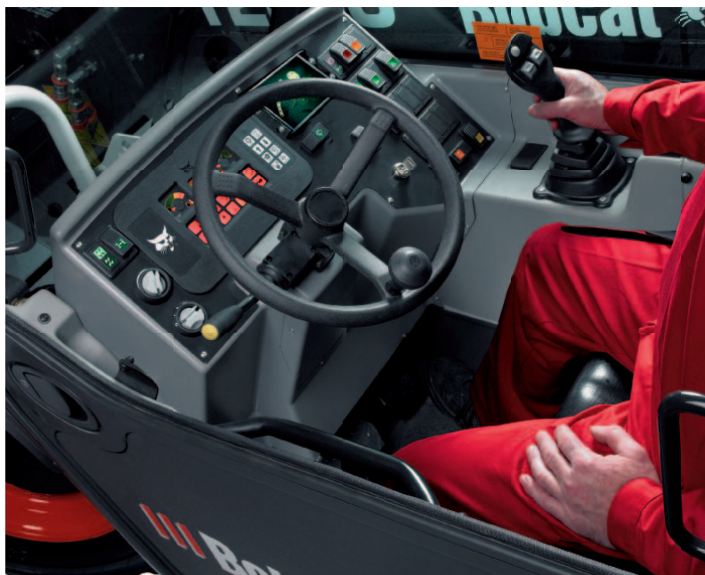
Figura 1.10: Cabina di comando del sollevatore telescopico T2250 prodotto da Bobcat.
