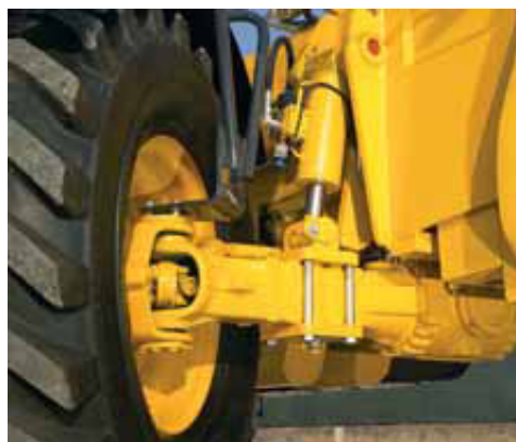
(b) Sistema di bloccaggio dell'assale posteriore per aumentare la stabilità laterale.
