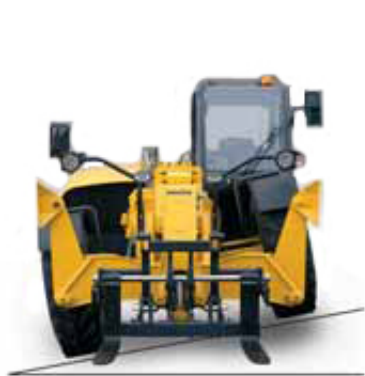
(a) Sistema per mantenere livellato il telaio.
