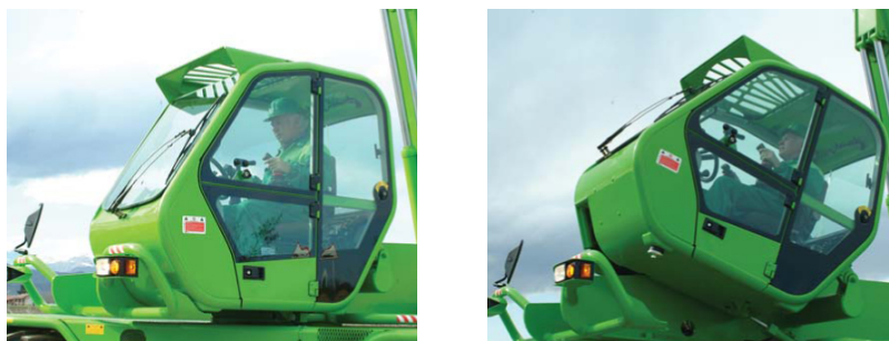
Figura 1.8: Esempio di cabina inclinabile (da 0^\circ a +18^\circ ) fornita dal sollevatore telescopico ROTO 40.25 MCSS prodotto da Merlo per migliorare la visibilità dell'area di lavoro durante l'esecuzione di manovre ad altezza elevata.
