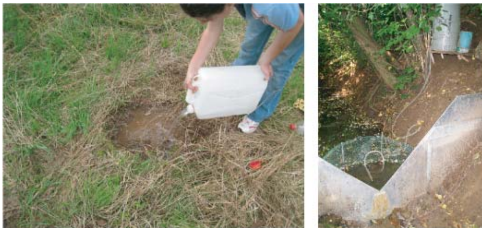
Figura 1.45: Prova con tracciante: iniezione soluzione LiCl; campionamento allo stramazzo con campionatore ISCO.
