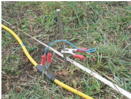
(b) Picchetto metallico per l'acquisizione tomografica.
