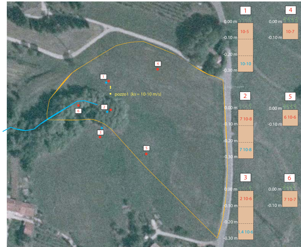
Figura 1.43: Conducibilità idrauliche sature ( k_{sat} ) valutate a differenti profondità e in diversi punti: in dettaglio, nelle posizioni 1, 2 e 3 sono state misurate sia per campioni a profondità tra 20 e 30 cm rispetto al piano campagna (in azzurro) sia per campioni più superficiali (tra 0 e 10 cm); per i punti 4, 5 e 6 le k_{sat} sono valutate solo per i campioni più superficiali. I valori sono espressi in m/s . In giallo è segnata la posizione dei pozzi: per il pozzo 1 si riporta la permeabilità media valutata.
