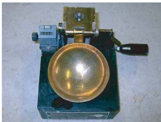
Figura 1.22: Cucchiaio di Casagrande.
