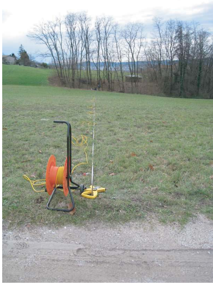
(a) Stendimento per la tomografia elettrica lungo la linea Linea 2 (18/12/08).
