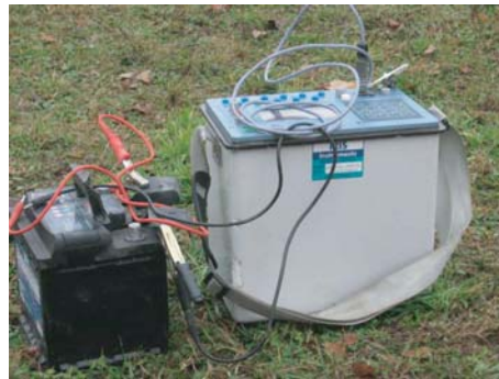
(c) IRIS Syscal Pro a 48 canali.
