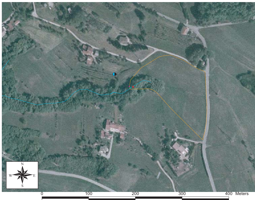
Figura 1.4: La linea arancione rappresenta il limite del bacino di studio, chiuso alla sezione con gli strumenti di monitoraggio; in rosso è indicato lo stramazzo; il cerchietto nero-azzurro rappresenta il pluviometro.
