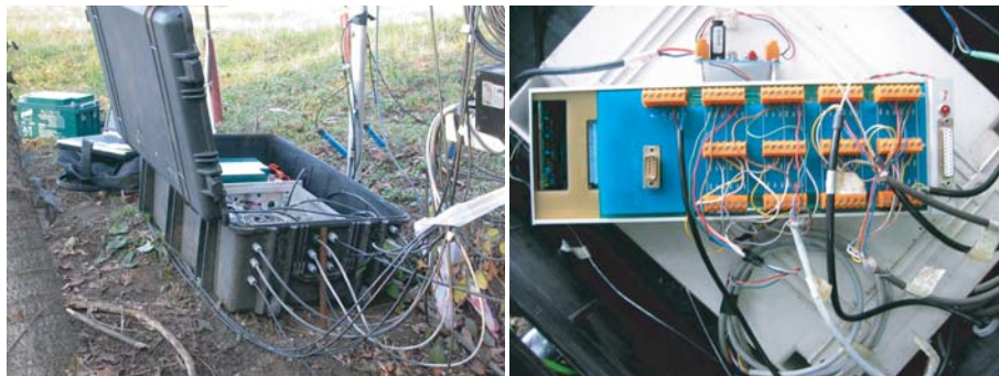
Figura 1.6: Cassetta contenente datalogger e batteria 12V per alimentazione; a destra, il datalogger GEOLÓG, utilizzato per le acquisizioni dei sensori in sito.
