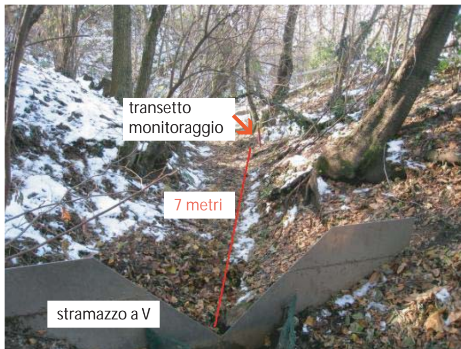
Figura 1.18: Stramazzo installato in sito: vista da monte; Transetto sullo sfondo.
