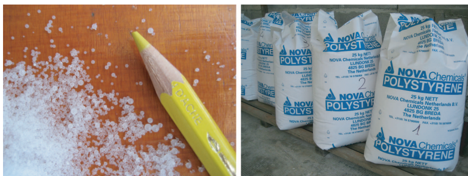
Figura 2.7: Granuli sferici di polistirene utilizzati per riprodurre la topografia del fondo. A destra : eterogeneità del diametro dei sedimenti; a sinistra : sacchi contenenti le microsferiche di polistirene.
