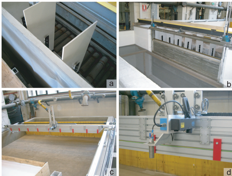
Figura 2.4: Componenti principali dell'apparato sperimentale. a) Rotoli di rete metallica distribuiti al di sopra del tubo di alimentazione, setti verticali in pvc e rete metallica verticale. b) Paratoia con bordo affilato in acciaio. c) Carroponte in alluminio su cui sono montati il laser e la sonda ad ultrasuoni. d) Accoppiamento laser-sonar.
