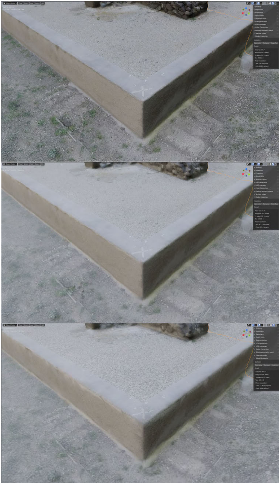
Figura 4.13: Dall’alto in basso, il confronto tra le texture della tile 3D numero 38, osservata all’interno di Blender in modalità material preview , dopo essere stata decimata tramite il LOD Generator di 3DSC. A partire dal cosiddetto LOD0, figura in alto, sono stati successivamente ottenuti il LOD1, figura in mezzo, e il LOD2, figura in basso, con una riduzione del 50% della texture di entrambi i LOD.
