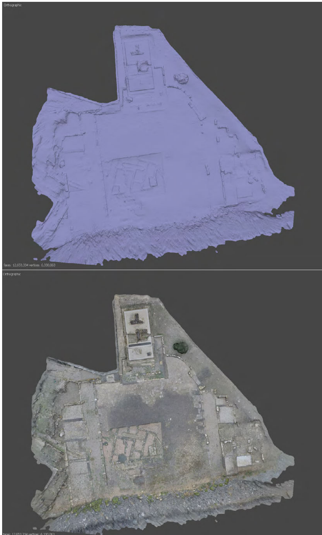
Figura 4.8: In alto, la mesh poligonale del foro priva di informazioni colore derivate dalle immagini. In basso, la stessa mesh con rappresentata l'informazione colore attribuita tramite vertex color . La texture fotorealistica sarà calcolata in un secondo momento e verrà applicata al modello segmentato, non a quello complessivo qui rappresentato.
