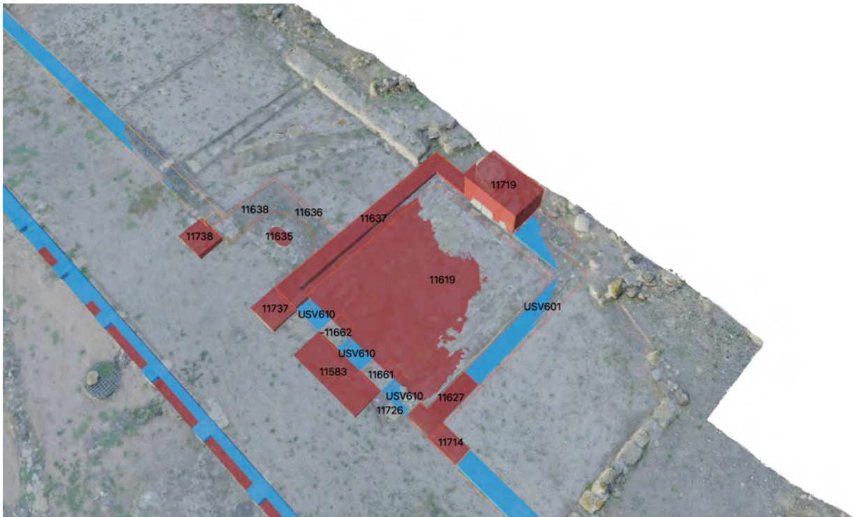
Figura 5.91: Vista panoramica della curia con indicate US e USV relative a: le fondazioni dei perimetrali (11637, 11627, USV601), l'alzato conservato (11719), il lato su cui si aprivano gli ingressi (-11662, 11661 e USV610), la pavimentazione (11619), la pavimentazione del portico (11583).
