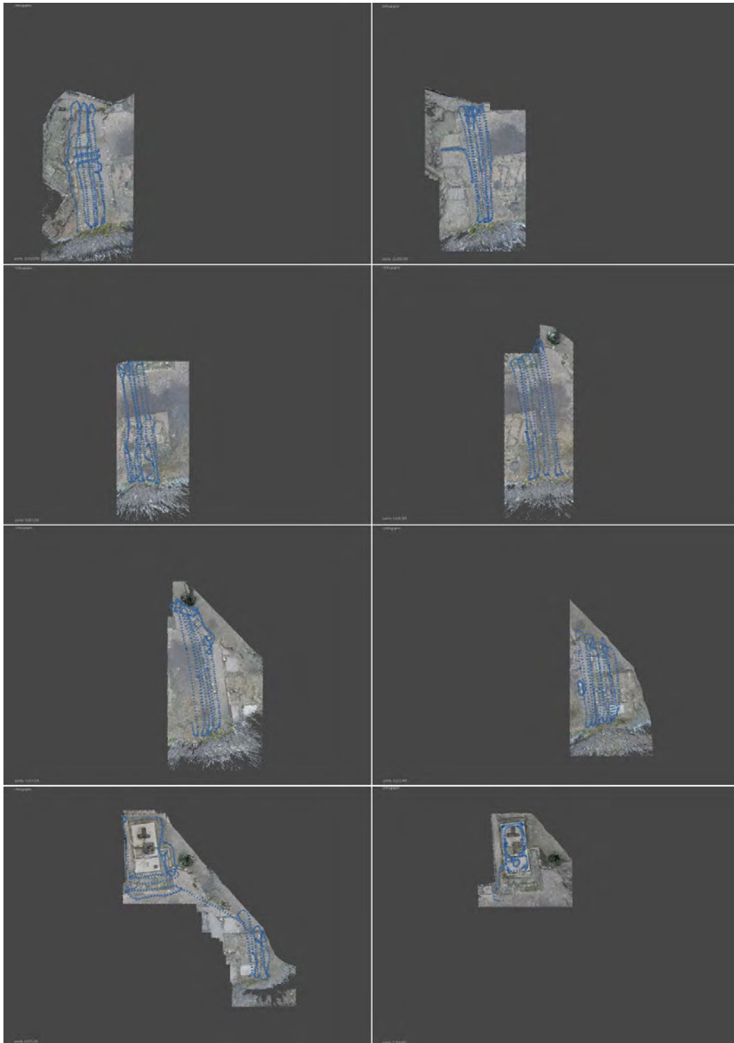
Figura 4.6: Le 8 nuvole di punti risultanti dal processo di dense cloud calculation a cui sono state sottoposte le sparse cloud dei singoli dataset. La forma regolare di alcuni dei profili di queste nuvole è dovuta al fatto che l'elaborazione di ogni singolo chunk è avvenuta all'interno di un determinato spazio operativo (la cosiddetta Region di Metashape).
