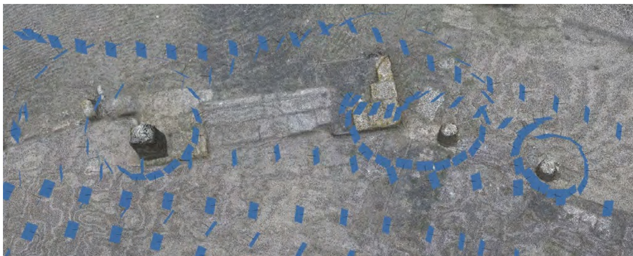
Figura 4.2: Laddove necessario le traiettorie di acquisizione hanno seguito un andamento differente dalle strisciate parallele. Nell'immagine si possono notare tre traiettorie circolari le quali sono state compiute per rilevare un basamento di statua e due rocchi di colonna in prossimità dell'ingresso orientale del foro.
