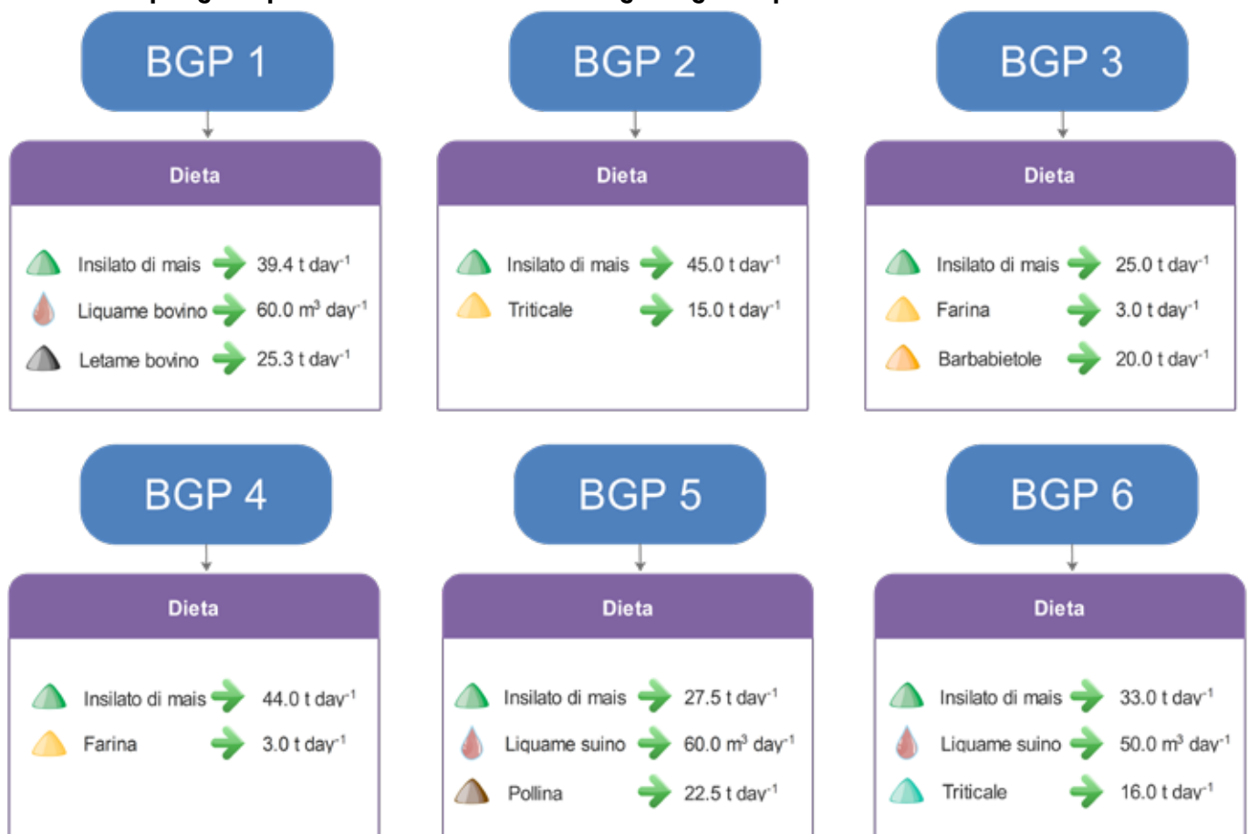
FIGURA 1 - Tipologia e quantità di substrato inserito in ogni singolo impianto
