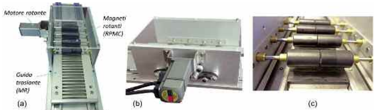
Figura 4 - (a): RLMC con magneti fissi e guida mobile ( n_m=4 , n_c=1 ); (b): trasmissione a cinghia; (c): posizionamento dei magneti cilindrici e piani con guida rimossa.
