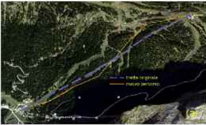
Figura 9 - (a): visualizzazione su Google Maps e (b) profili altimetrici del percorso dell'attuale impianto di risalita e del percorso alternativo per il nuovo sistema di propulsione proposto
