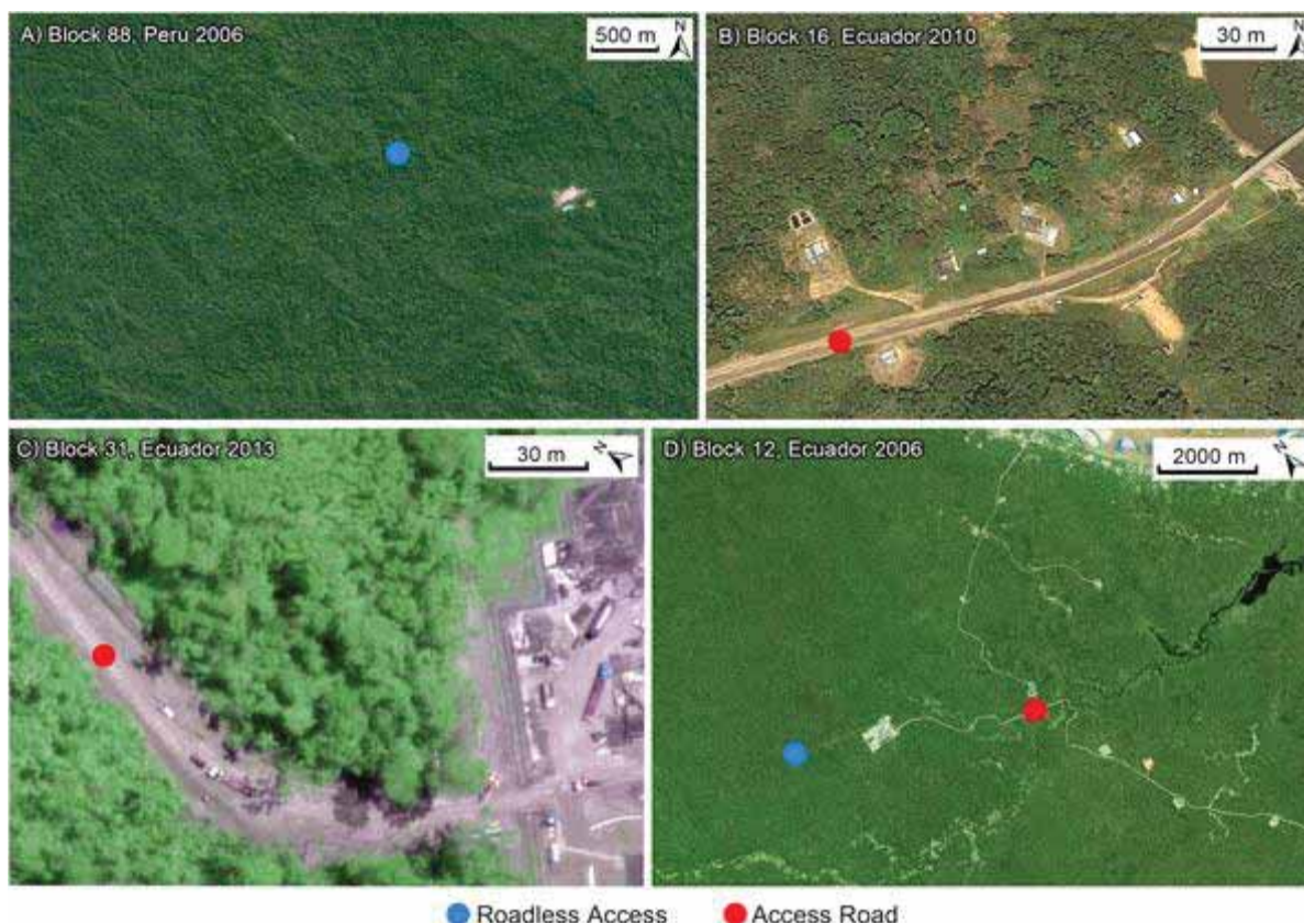
Fig. 2: casos específicos de vías de acceso sin caminos y accesos con caminos. (a) Bloque 88 (Camisea), Perú. Las imágenes de Google Earth de julio de 2006 muestran una línea de flujo sin caminos, que se extiende al oeste de una plataforma de perforación. (b) Bloque 16, Ecuador. Las imágenes de Google Earth de septiembre de 2010, muestran un camino de acceso antiguo y la colonización y deforestación asociada a éste. (c) Bloque 31, Ecuador. Las imágenes de Worldview 2, de septiembre de 2013, muestran un camino de acceso moderno. (d) Bloque 12, Ecuador. Las imágenes de Google Earth de septiembre de 2006, muestran una planta de procesamiento en el centro, con un oleoducto sin caminos hacia el oeste, y un camino de acceso que va hacia el Este. Los colores de los puntos corresponden a la figura 1 (es decir, punto rojo = camino de acceso, punto azul = sin camino de acceso).
