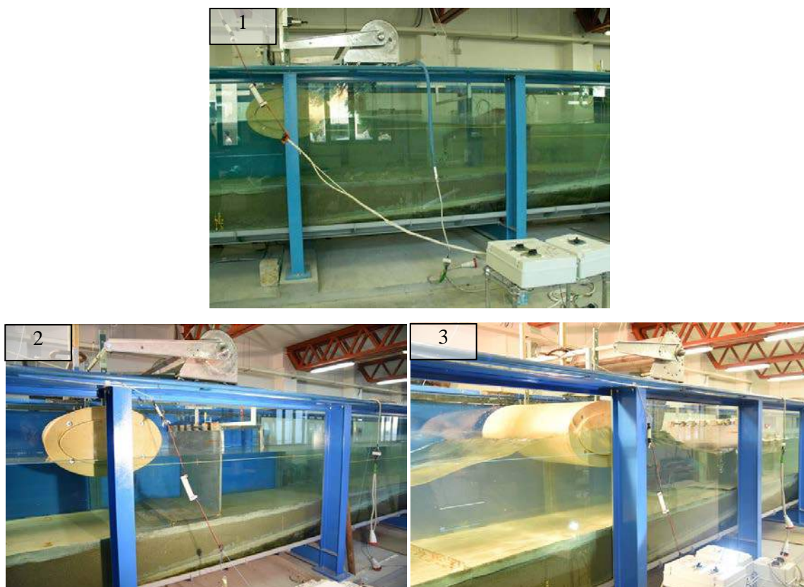
Figura 1. Il convertitore ShoWED in tre configurazioni: 1) senza parete riflettente a tergo; 2) con parete verticale posta a 80cm; 3) con parete verticale posta a 120 cm.
