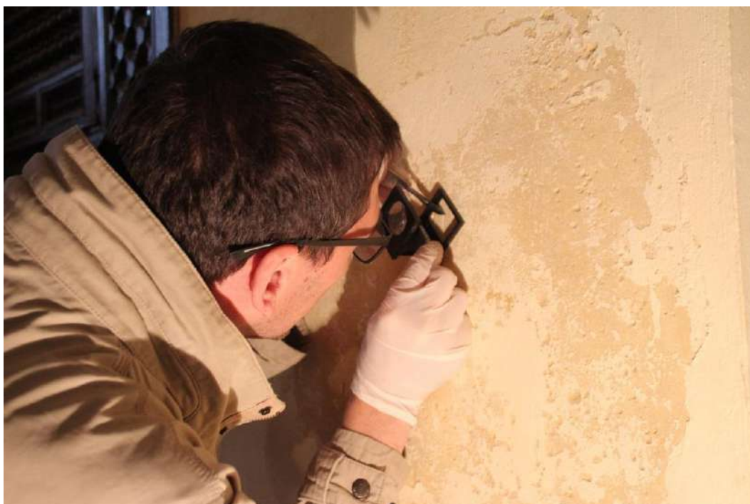
Fig. 10 Studio degli intonaci e del degrado al fine di posizionare il sondaggio stratigrafico
