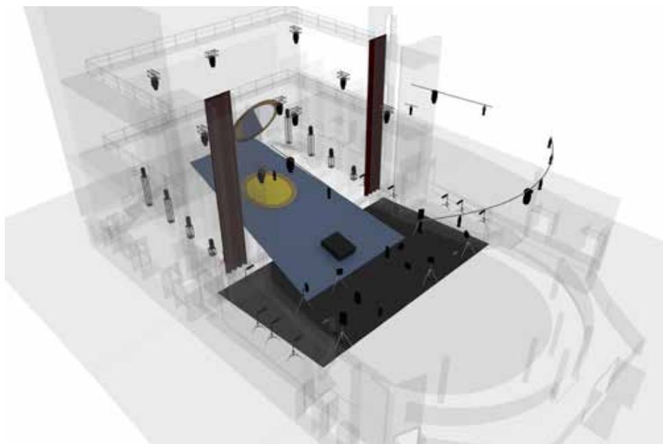
Pasquale Mari, Pianta dell'allestimento di Solaris al Teatro Modena di Genova, con Rilievo-Assonometria (i colori presenti in tavola servono ad evidenziare le diverse superfici e non corrispondono a quelli della realizzazione scenica). Disegno: Gianni Grasso, capo elettricista e operatore alla consolle luci.
