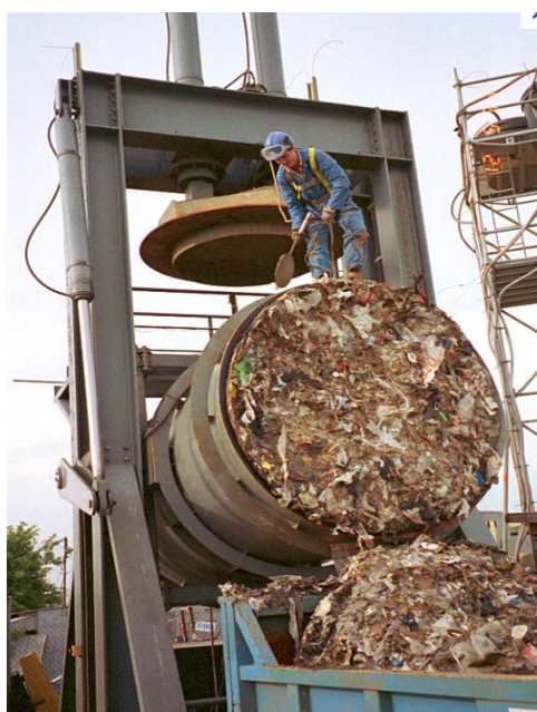
Fig. IV-17. Cella di compressione di Pitsea, utilizzata per lo studio di parametri geotecnici su diverse tipologie di rifiuti urbani (Beaven e Powrie, 1995).
