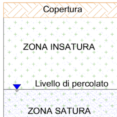
Fig. I-4. Rappresentazione schematica della zona satura ed insatura, all'interno di un cumulo di rifiuti.
