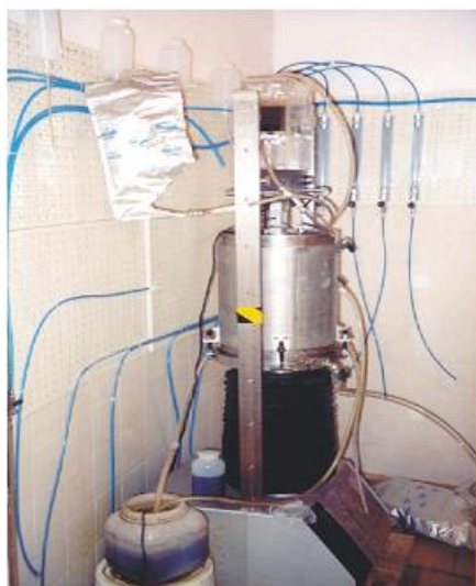
Fig. V-1. Apparecchiatura edometrica utilizzata per le prove di compressione su miscele di rifiuto (Carrubba e Cossu, 2003).
