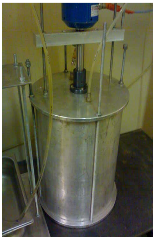
Fig. VI-19. Schematizzazione (misure in cm) e immagine del reattore utilizzato per il test sul rifiuto pretrattato.
