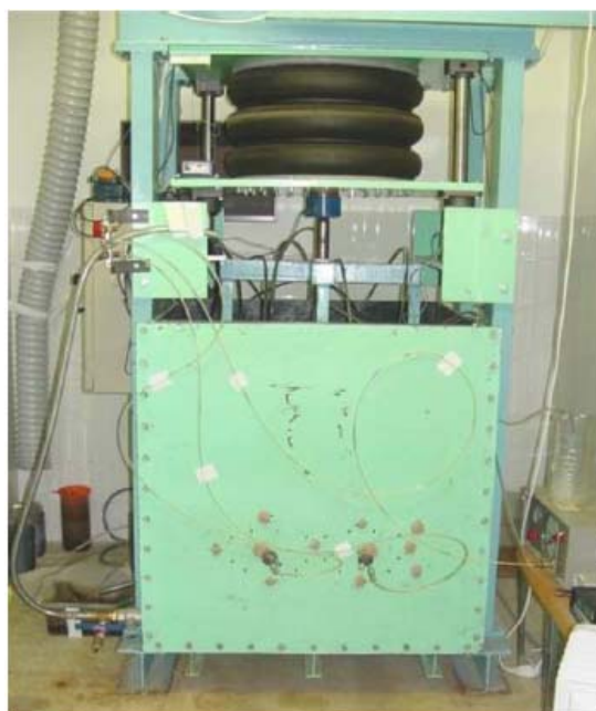
Fig. IV-18. Cella di compressione utilizzata da Olivier e Gourc (2007).
