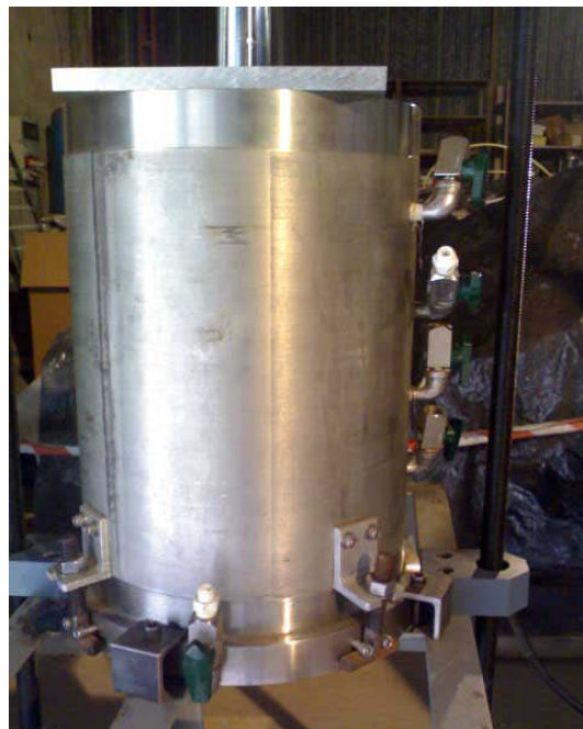
Fig. VI-6. Schema e immagine del reattore utilizzato per il test sul rifiuto originario.
