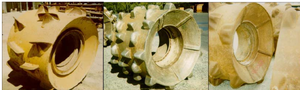
Fig. II-6. Esempio di ruote di compattatori normalmente utilizzate in discarica.
