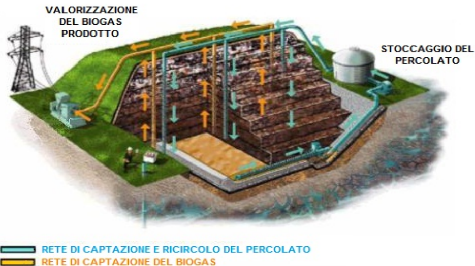
Fig. 23. Schema di una discarica bioreattore (adattata da Staub, 2010).
