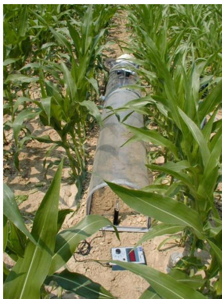
Figura 8.3 - Tunnel in plexiglas impiegato per la rilevazione della volatilizzazione dell'ammoniaca.
