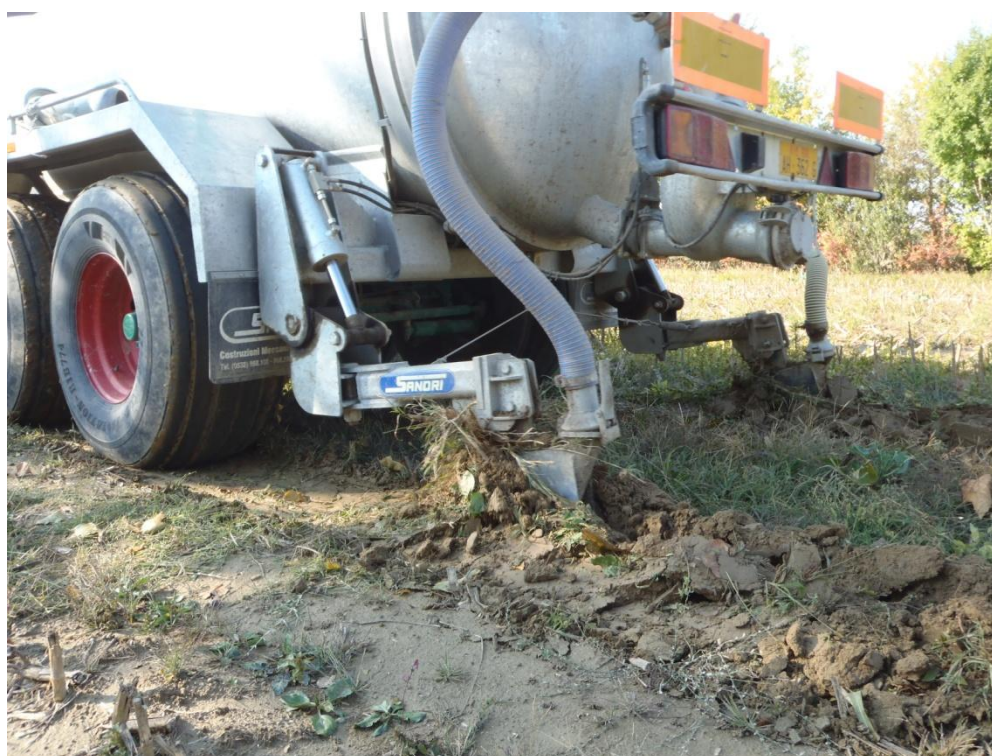
Figura 7.2 - Interratore in grado di iniettare il liquame ad una profondità di 40 cm.
