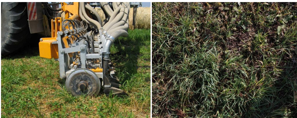
Figura 3.32 - Barra con interratori a disco a solco aperto su prato(a destra) e suo effetto(a sinistra).
