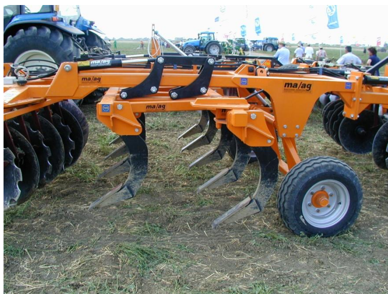
Figura 4.7 - Esempio di coltivatore combinato equipaggiato per la variazione dell'intensità di lavorazione all'interno dell'appezzamento mediante attuatori di tipo idraulico.
