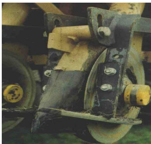
Figura 7.13 - Interratore superficiale con doppio disco e pattini costipatori laterali.
