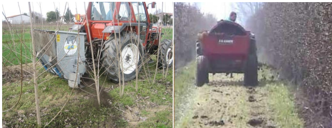
Figura 3.6 – Attrezzature aziendali per la distribuzione localizzata su vigneti e frutteti.
