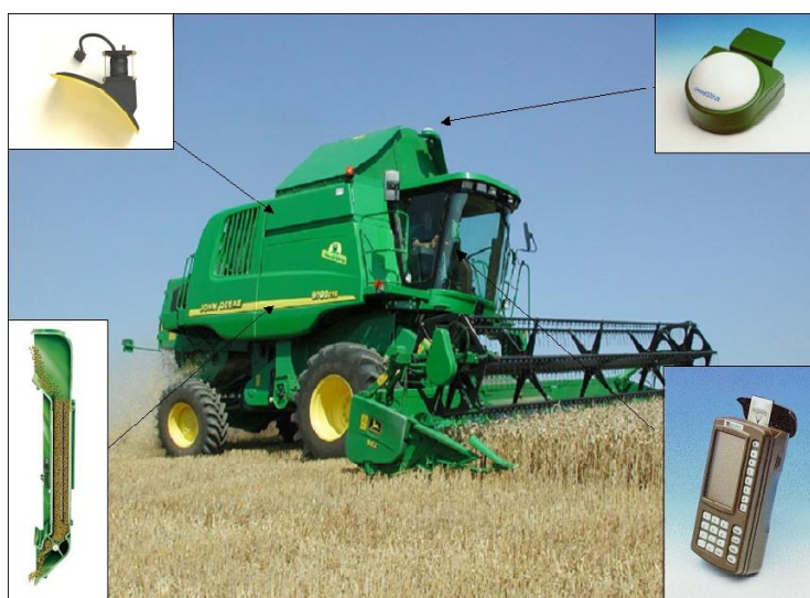
Figura 4.3 - Esempio di mietitrebbiatrice equipaggiata con un sistema per la mappatura delle produzioni.
