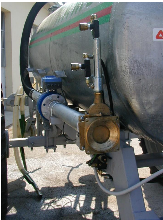
Figura 4.14 - Saracinesca ad azionamento idraulico.
