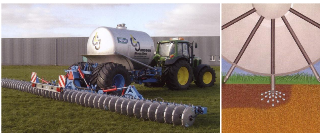
Figura 3.37 - Soluzioni per la distribuzione sottosuperficiale possono anche essere fra le più diversificate, come la macchina che localizza il liquame attraverso una serie di iniettori che si conficcano nel terreno e rilasciano una certa quantità di prodotto.
