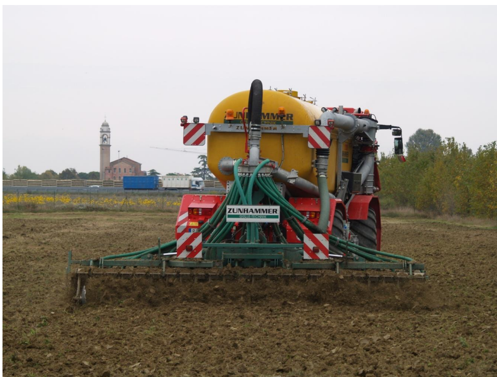
Figura 7.1- Distribuzione interrata di liquame zootecnico.
