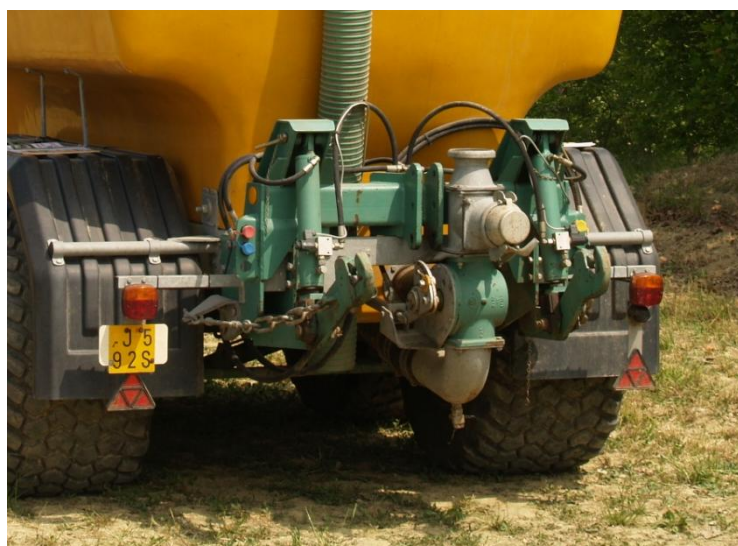
Figura 7.5 - Attacco a 4 punti: permette il collegamento carrobotte- interrattore.
