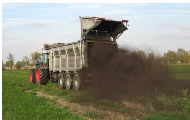
Figura 6.4 – Spandicompost della ditta Franzosi in distribuzione.
