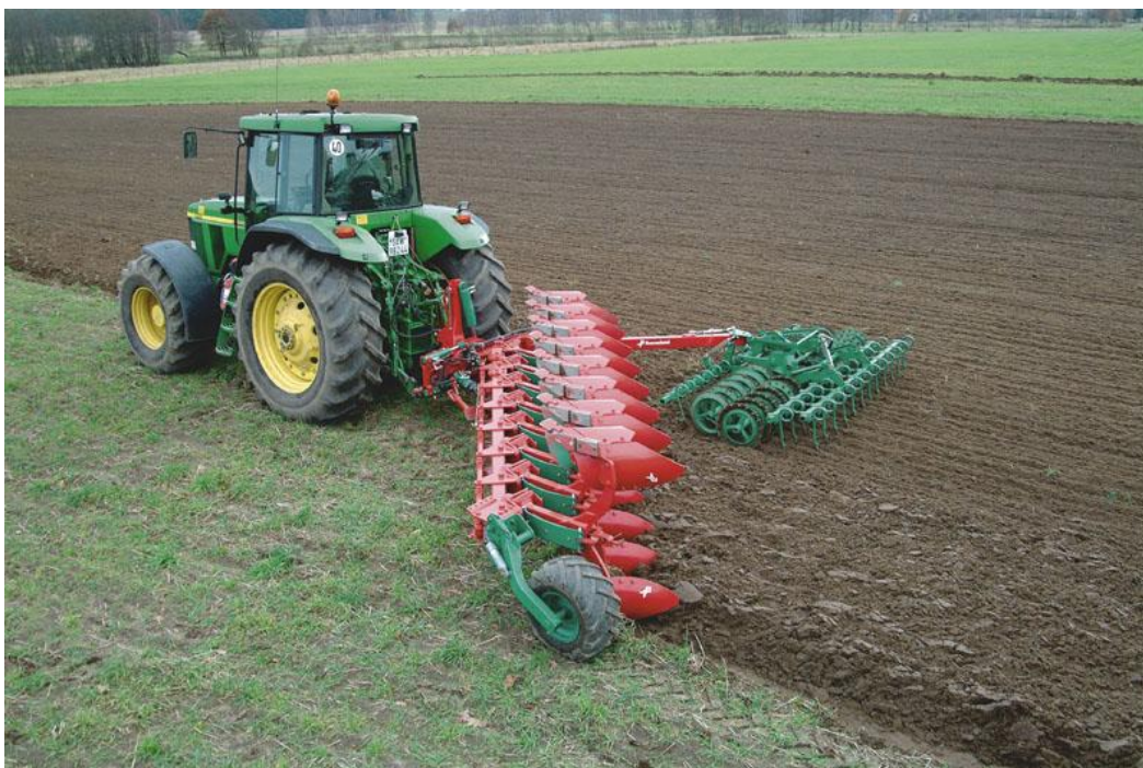
Figura 3.30 – Incorporazione del liquame con aratro superficiale lavorante a 15 cm di profondità.
