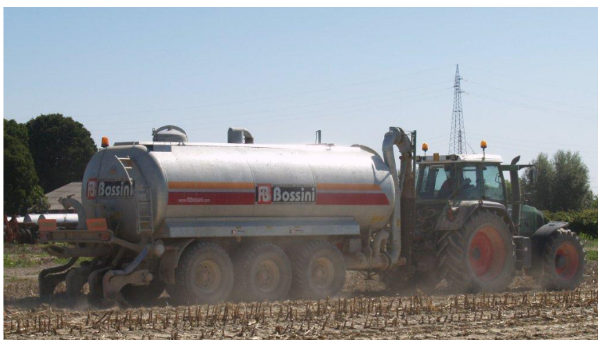
Figura 9.10 – Il carrobotte a 3 assi Bossini in fase di distribuzione interrata.
