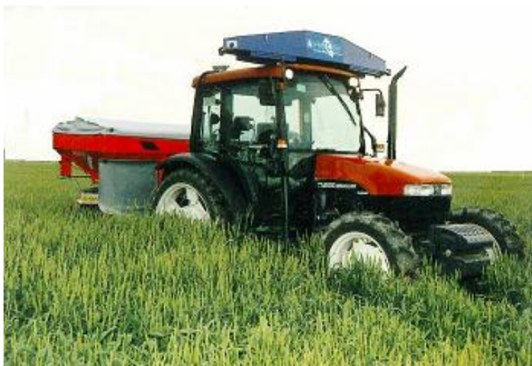
Figura 4.6 - Sistema per la distribuzione a dosaggio variabile dell'azoto basato sulla presenza di un sensore di riflessione della luce da parte della coltura.
