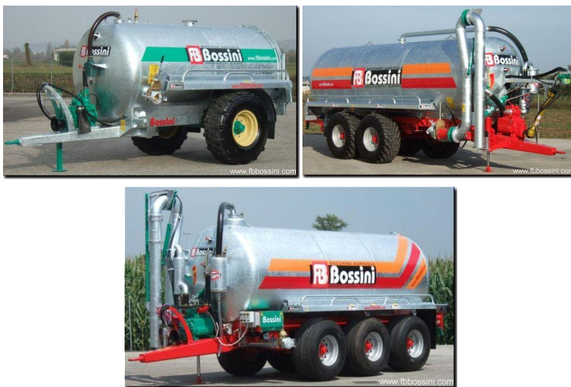
Figura 3.17 – Esempi di rimorchi di tipo “carrobotte” ad un assale di tipo tradizionale (in alto a sinistra), a due assali ravvicinati (in alto a destra), a tre assali ravvicinati (in basso) (figure tratte da: www.fbbossini.com ).
