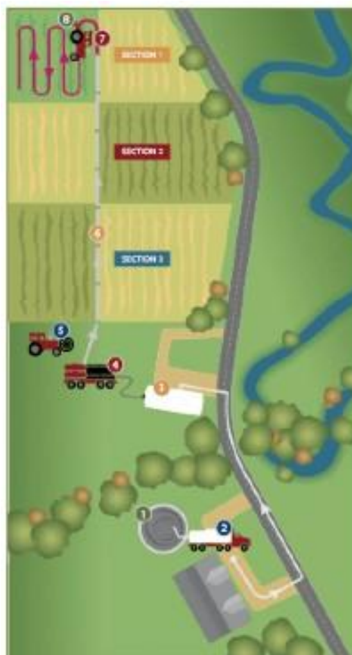
Figura 3.23 – Utilizzazione di un sistema di tubazioni per lo spandimento del liquame situato oltre 2-10 km la vasca di stoccaggio. 1 – pompa agitatrice, 2 – trasporto su strada, 3 – vasca di appoggio, 4 – pompa, 5 – rotolone, 6 – tubo di alimentazione, 7 – tubo di spandimento, 8 – distribuzione.
