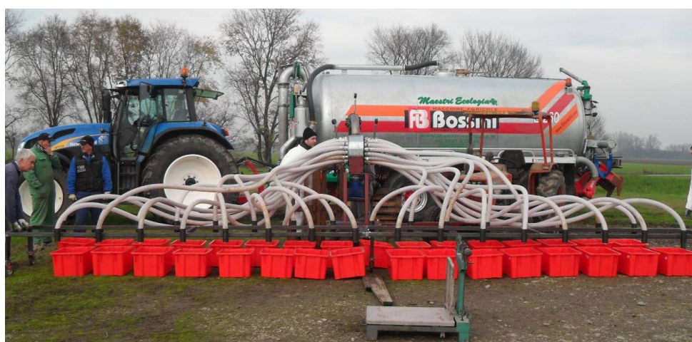
Figura 6.7 – Configurazione di prova del ripartitore; sono visibili: il carro botte e il trattore necessario per l'azionamento del motore idraulico del ripartitore, le tubazioni flessibili terminanti in
