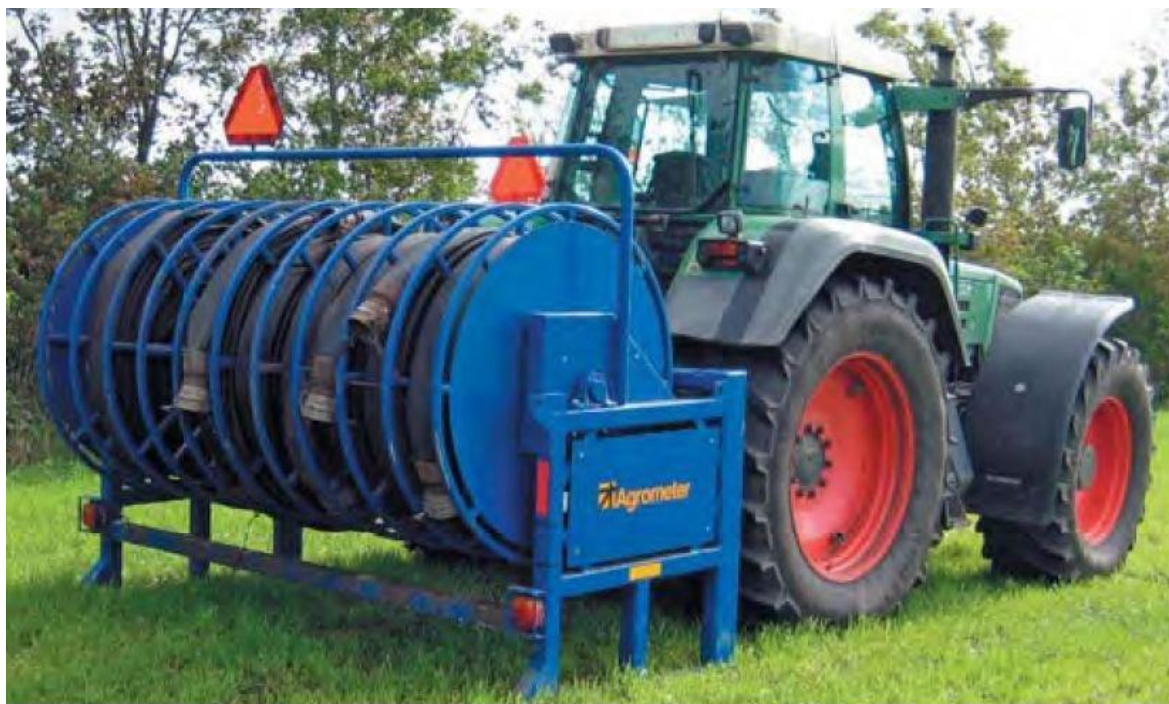
Figura 3.24 - Aspo avvolgi tubo equipaggiato con tubo collassabile.
