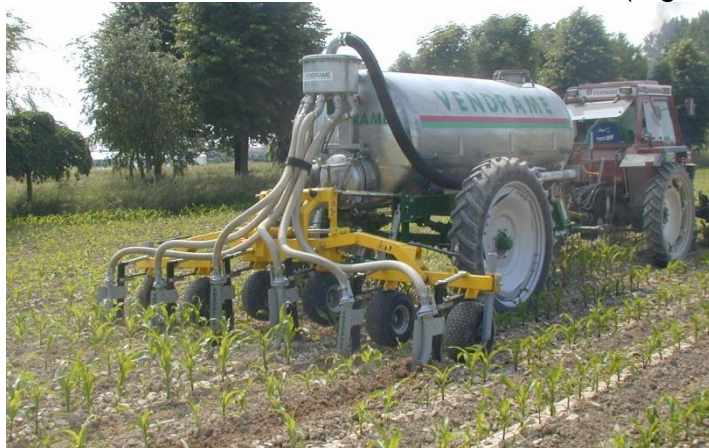
Figura 8.1 – Intervento in copertura su mais con distribuzione sottosuperficiale a solco chiuso.
