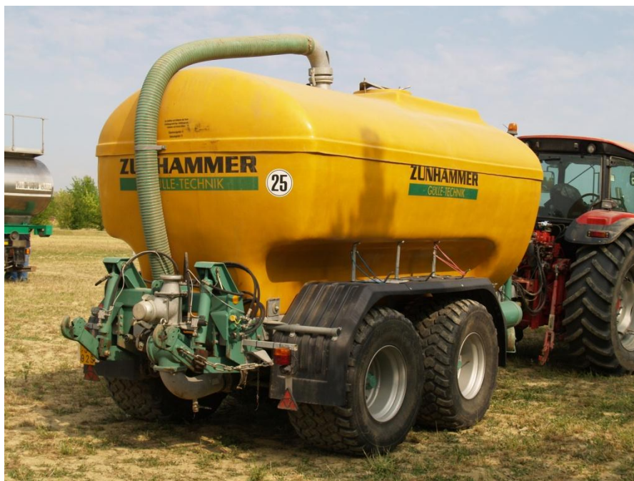
Figura 9.2 - Carrobotte di grandi dimensioni con serbatoio in poliestere con rinforzi in fibra di vetro e pneumatici a bassa pressione.
