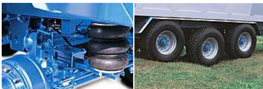
Figura 9.7 - Insieme balestra parabolica più soffiato ad aria: consente una buona e costante distribuzione dei pesi su tutte le ruote nonché un buon assorbimento delle asperità del terreno su strade sconnesse.
