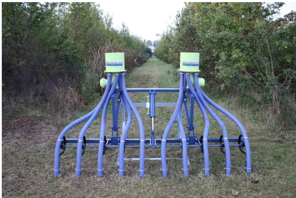
Figura 10.1: Barra completa sganciata dal carrobotte.
