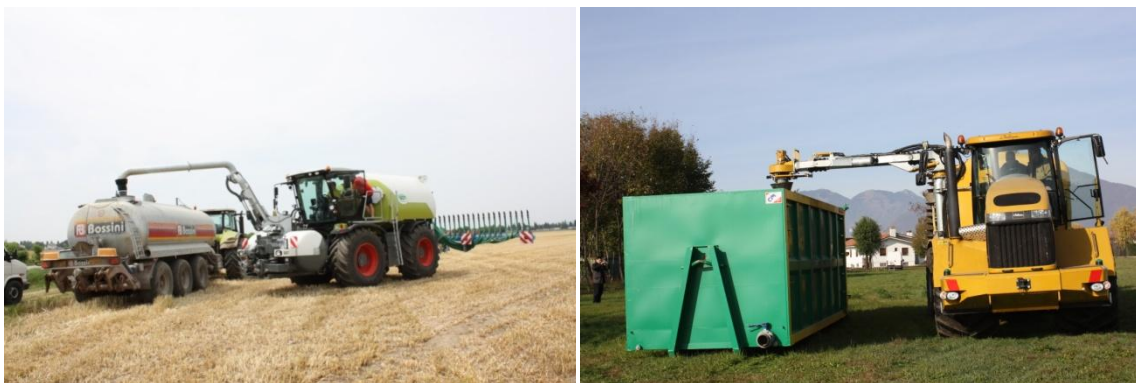
Figura 3.21 – Cantiere di rifornimento di un carrobotte semovente. A sinistra, con prelievo diretto da navetta. A destra, prelievo da “polmone” di stoccaggio temporaneo.
