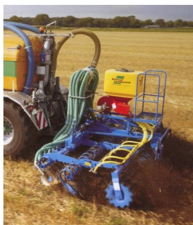
Figura 3.35 - Oltre alla barra ad ancore superficiali, possono essere proposte diverse soluzioni di coltivatori leggeri che oltre a distribuire il liquame, operino anche una lavorazione superficiale del terreno.
