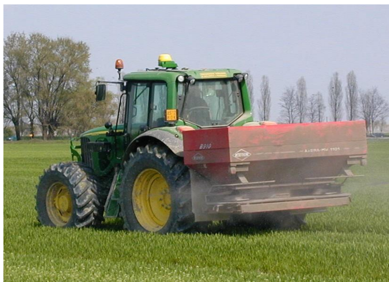
Figura 4.5.a - Esempio di distribuzione azotata a dose variabile in copertura su fumento mediante trattrice equipaggiata con ricevitore di posizione e unità di controllo, abbinata a spandiconcime centrifugo dotato di attuatore elettrico-idraulico.
