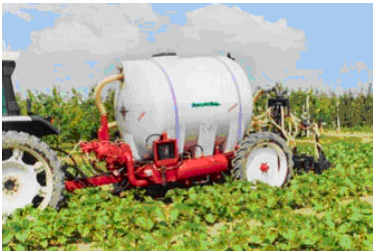
Figura 4.9 - Esempio di spandiliquame modulare per la distribuzione dei reflui in copertura.
