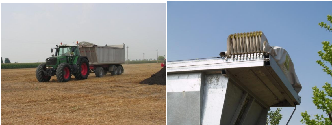
Figura 3.11 – A sinistra, rimorchio agricolo usato per trasportare i solidi palabili. A Destra, particolare del sistema di copertura automatico che evita la dispersione del materiale in trasporto.
