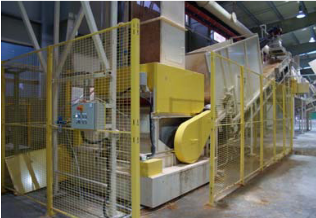
Figura 23 - Macchina per l'immersione in continuo nella soluzione salina
