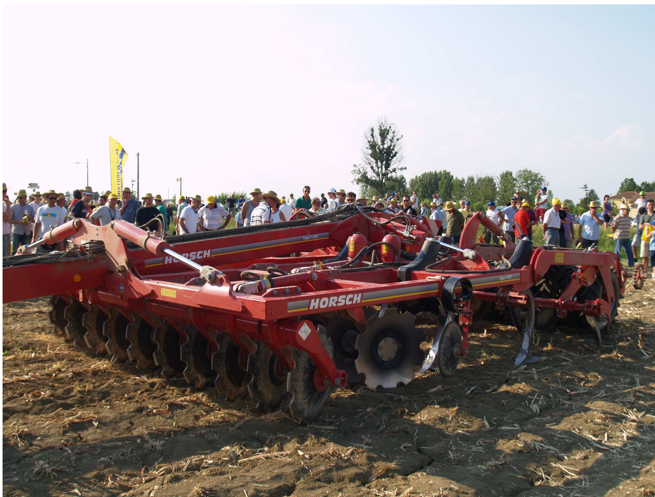
Figura 13: coltivatore combinato a dischi e ancore per minima lavorazione
