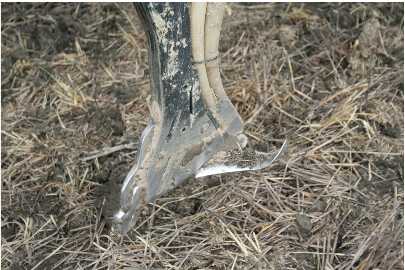
Figura 7: elemento di semina a T rovesciata
