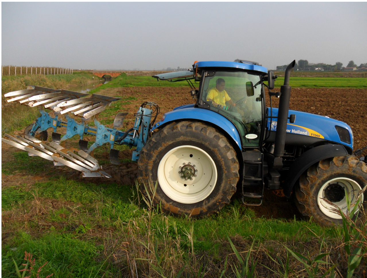
Figura 3: Aratro con versoi fenestrato. La capacità di frantumazione delle zolle è nettamente più elevata e l'energia d'applicazione è ridotta rispetto al tradizionale
