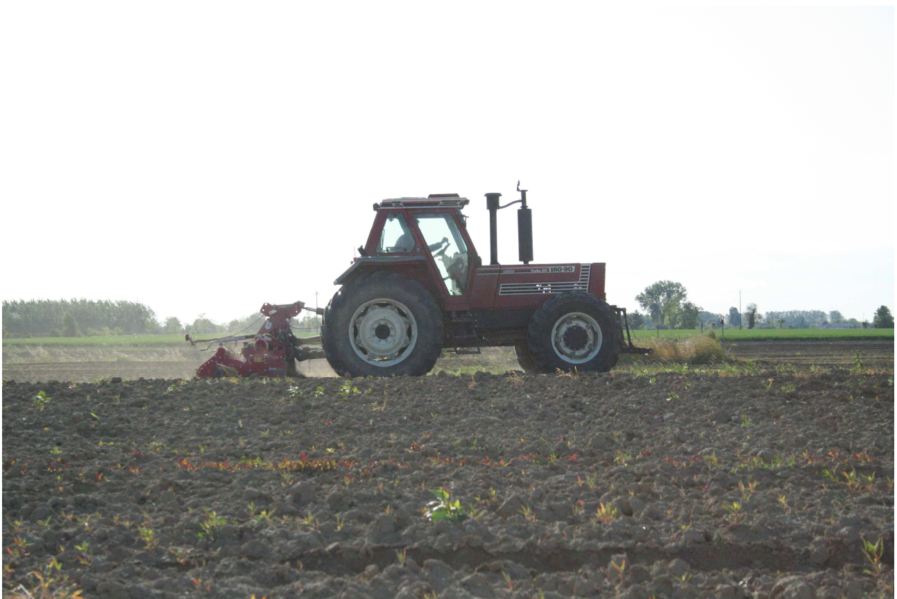
Figura 11: trattore con erpice rotante azionato dalla p.d.p.
