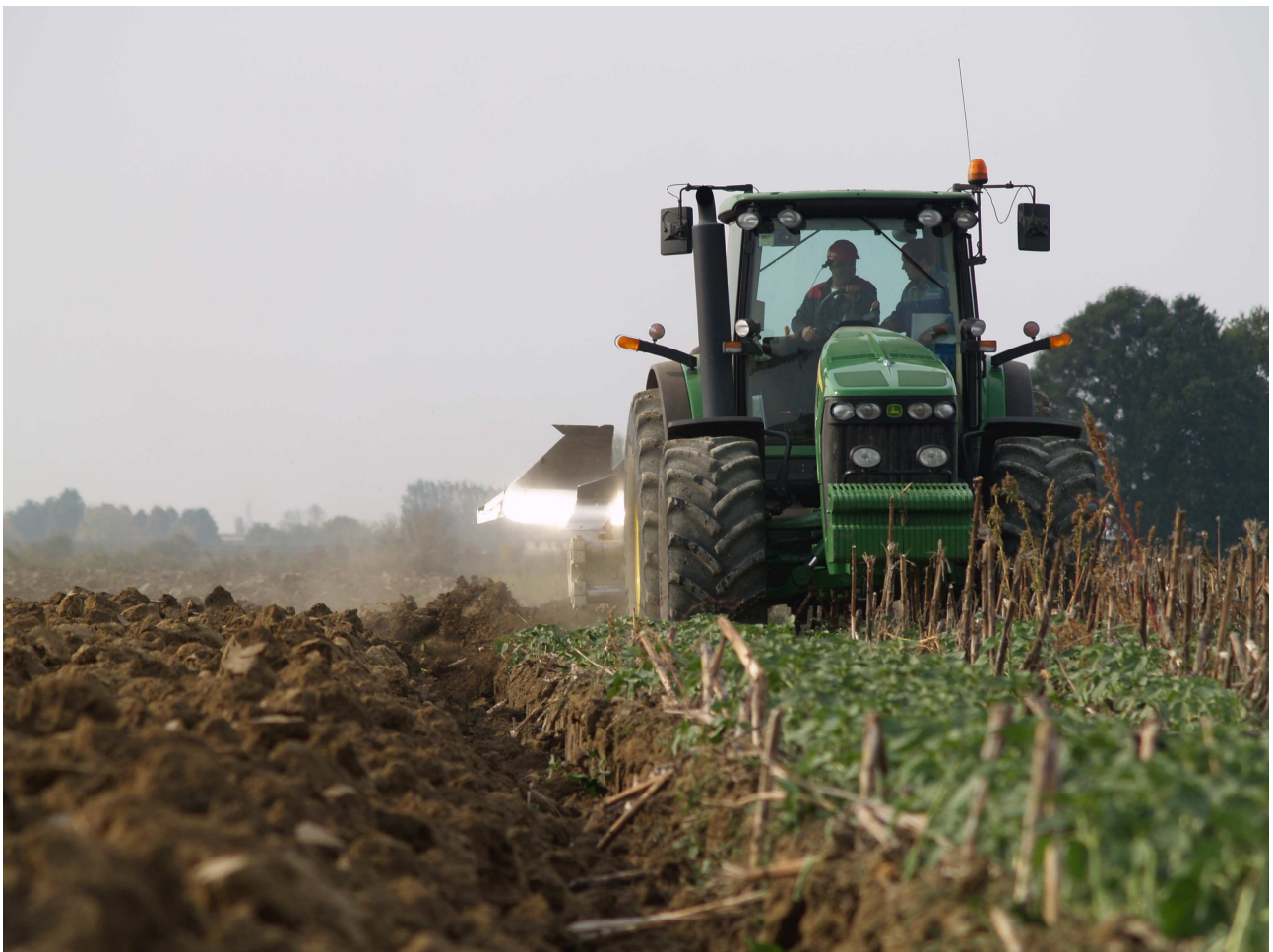
Figura 1: Aratura fuori solco con aratro a versoio intero e avanvomere per interrimento totale del residuo. Notare come sul terreno arato a sinistra della foto non è presente alcun residuo o infestante, mentre a destra è possibile notare la condizione di campo.
