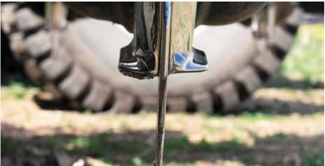
Figura 8: elemento di semina a croce realizzato e sviluppato dalla Cross slot
