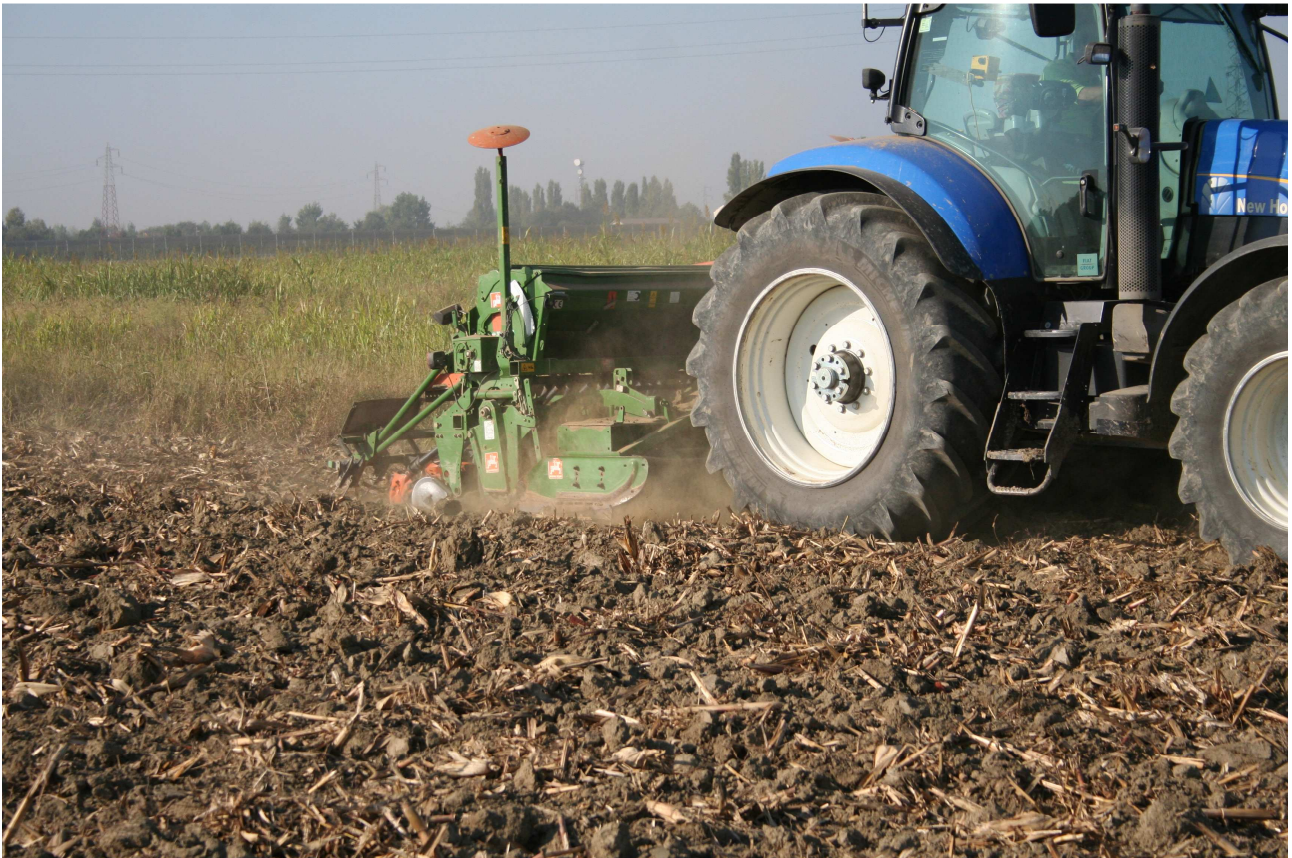
Figura 5: Seminatrice meccanica a file combinata ad erpice rotante per la semina di cereali autunno-vernini su terreno gestito a minima lavorazione.
