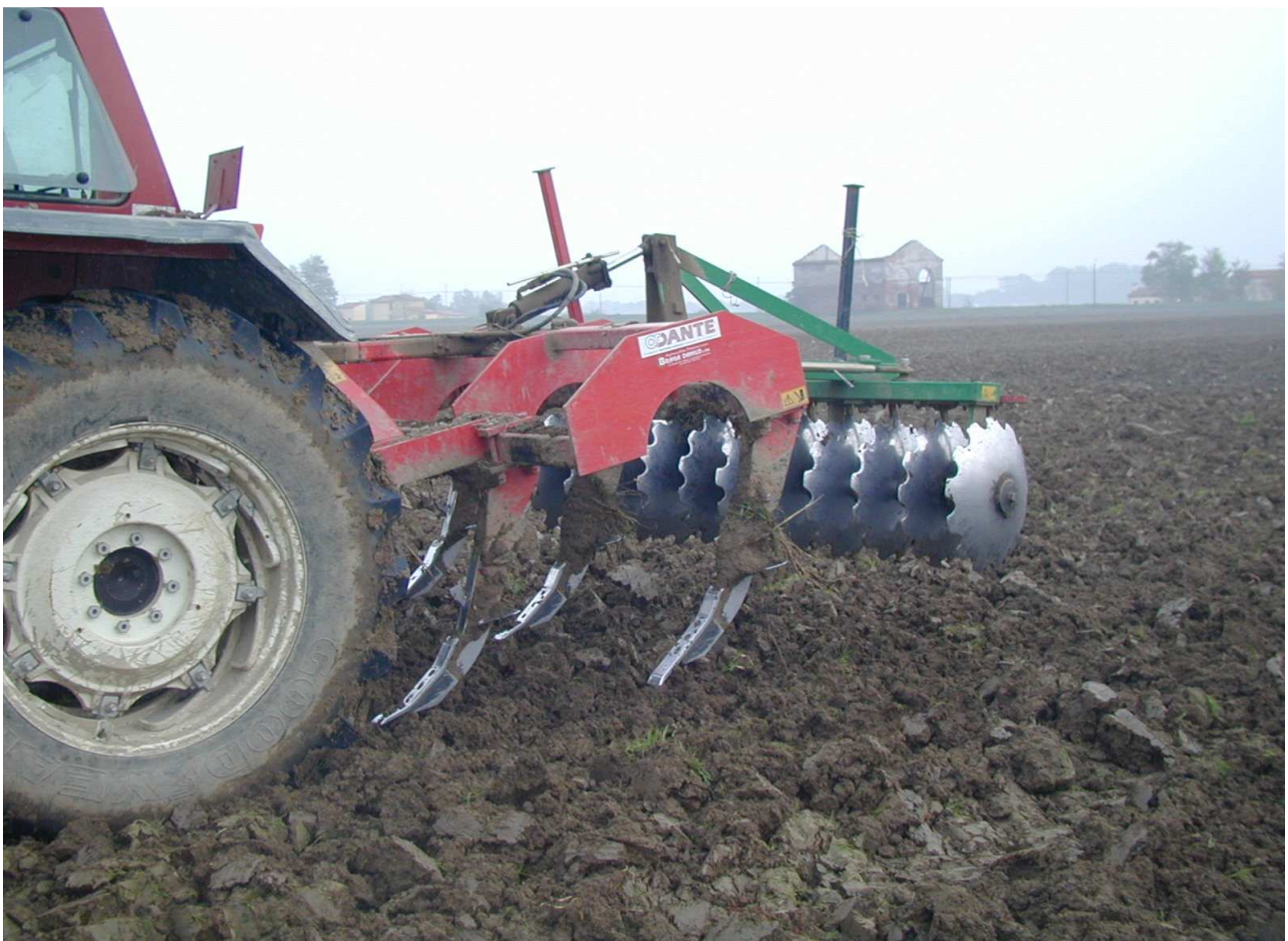
Figura 12: Dissodatore ad ancore inclinate con esplosori laterali, combinato con erpice a dischi monofila per un parziale affinamento
