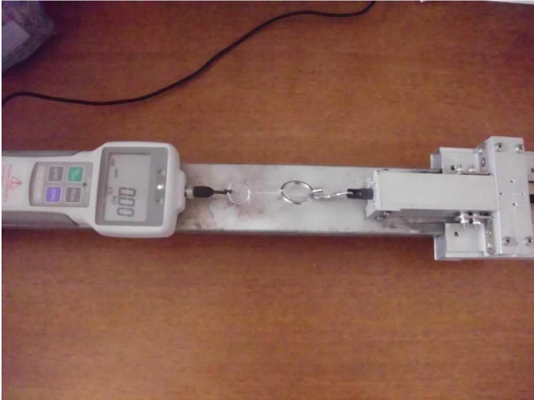
Figura 28: Banco dinamometrico con filamento da testare inserito tra 2 anelli portachiavi
