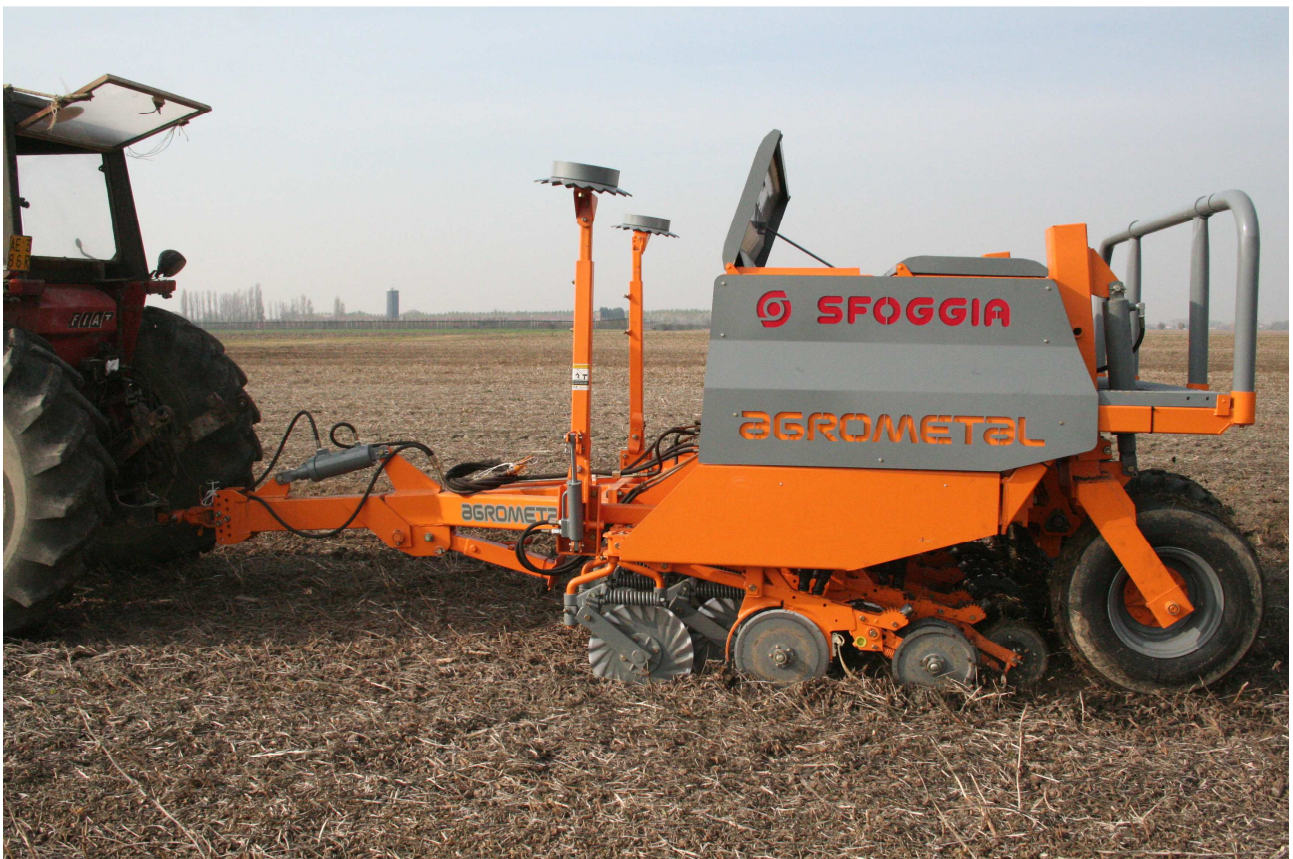
Figura 14: seminatrice per semina diretta in azione su residui colturali di soia per la deposizione del seme di frumento
