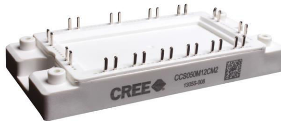
Fig. 8.2. H-bridge inverter module CREE CCS050M12CM2 [1]
