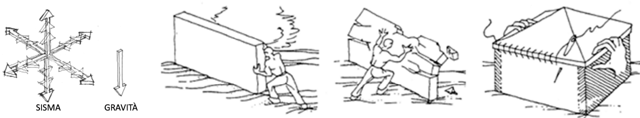
Figura 3.2: Azioni agenti in condizioni statiche e sismiche. Comportamento delle pareti a sollecitazioni nel piano e fuori piano, e concezione strutturale a "sistema scatolare" (figure di Touliatos, 1996)
