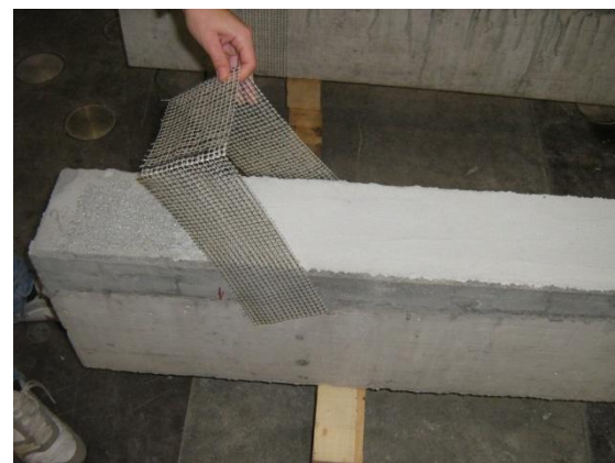
Figura 3.44: Fasciatura a U per evitare delaminazione
