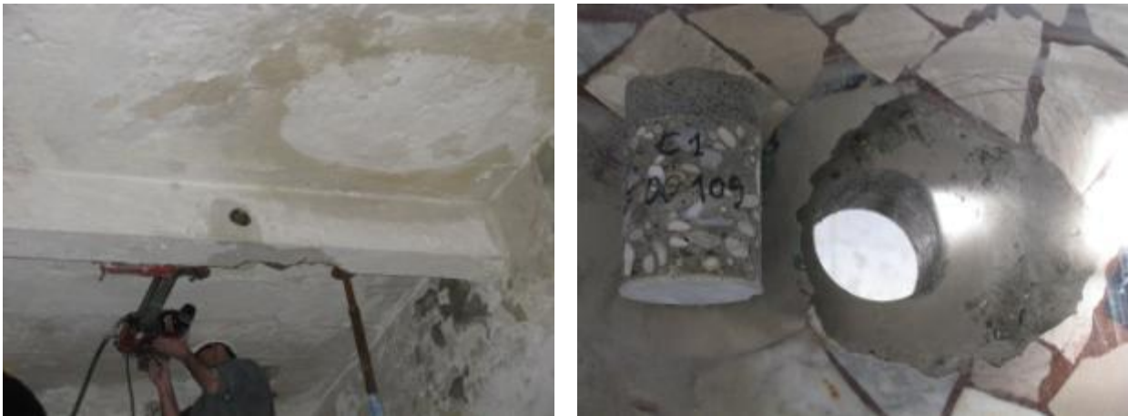
Figura 4.14: Esecuzione dei carotaggi a) su trave e b) su soletta
