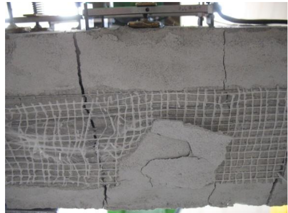
Figura 3.55: Particolari del distacco del rinforzo per matrice cementizia FR
