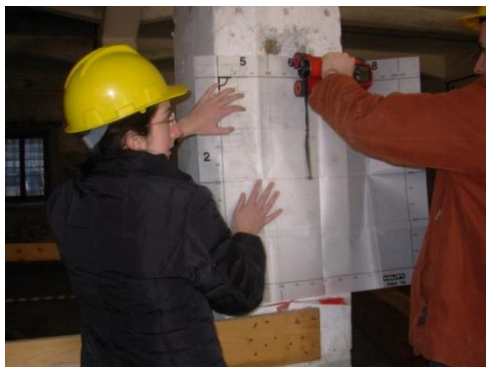
Figura 4.6: a) Passaggio della sonda sulla superficie e b) esempio di immagine restituita
