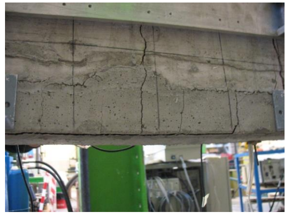
Figura 3.54: Particolari del distacco del rinforzo per matrice cementizia KF
