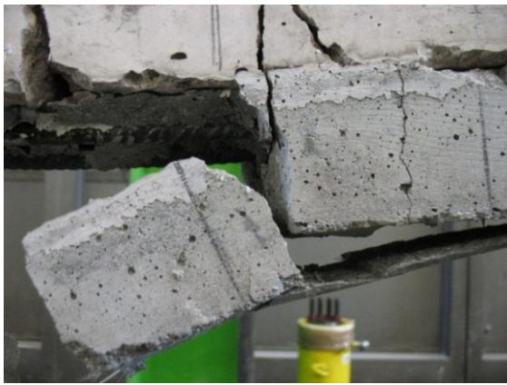
Figura 3.54: Particolari del distacco del rinforzo per matrice cementizia KF
