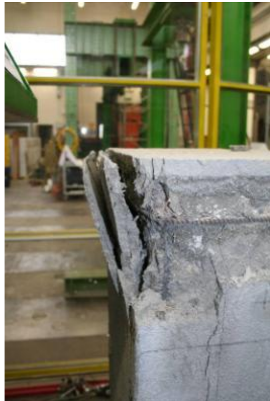
Figura 3.8: Quadro fessurativo delle colonne riparate con malta tipo ab
