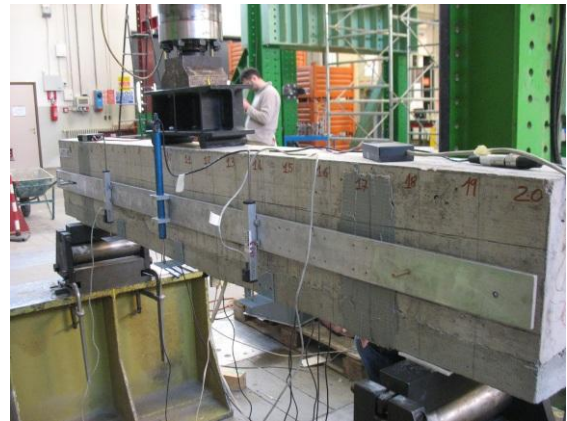
Figura 3.46: Strumentazione sul lato B della trave
