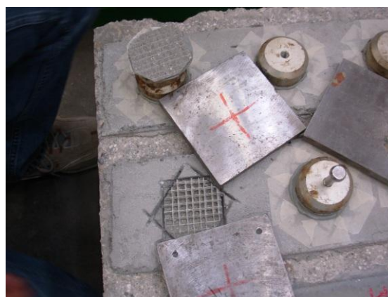
Figura 3.39: Rottura all'interfaccia rete di acciaio/matrice cementizia
