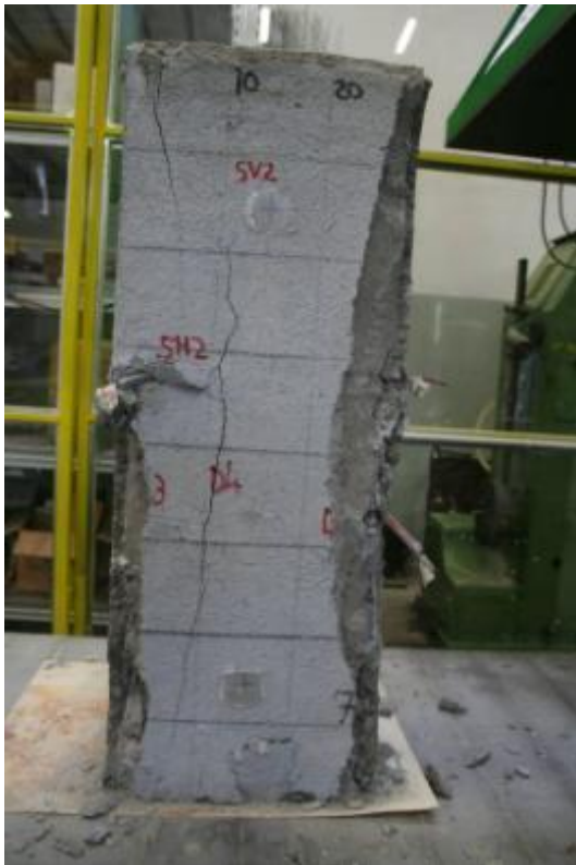
Figura 3.8: Quadro fessurativo delle colonne riparate con malta tipo ab
