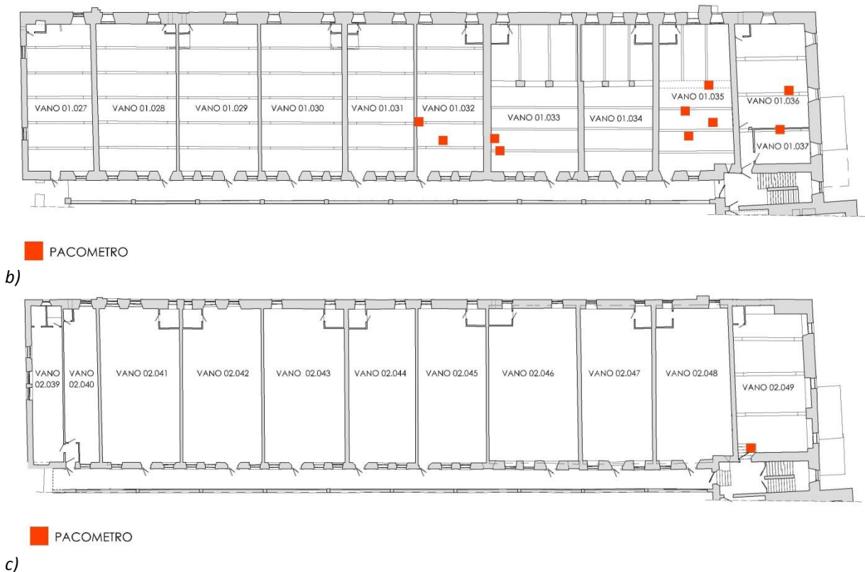
Figura 4.7: Posizione delle scansioni con pacometro eseguite a livello del a) primo, b) secondo e c) terzo solaio
