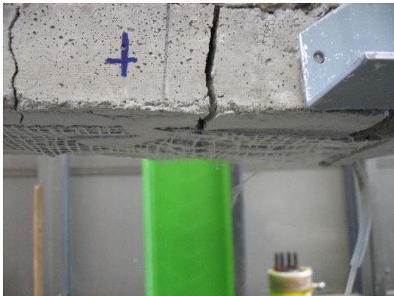
Figura 3.55: Particolari del distacco del rinforzo per matrice cementizia FR
