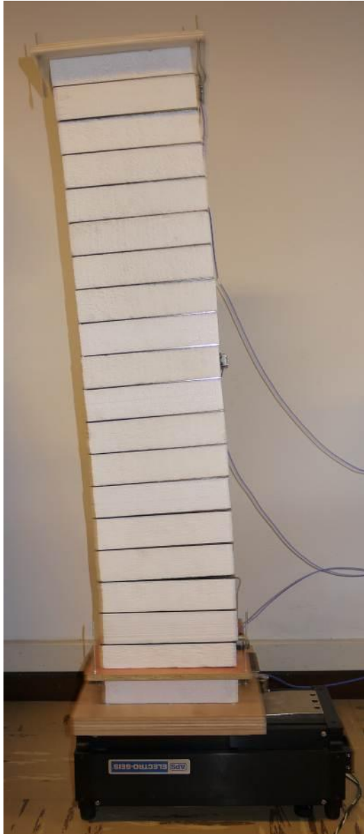
figura 2.105 - Modello MS(A) – fessurazione distribuita
