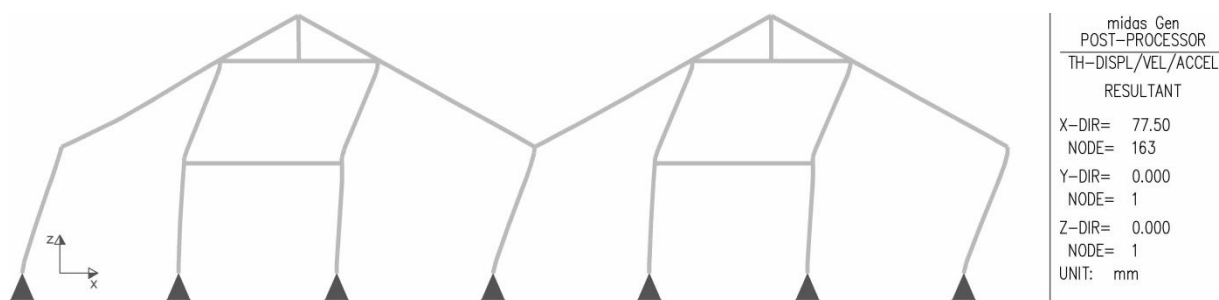
figura 1.154 – Deformata dei telai principali in corrispondenza del raggiungimento della capacità di rotazione ultima delle colonne – distribuzione dei carichi (II)
