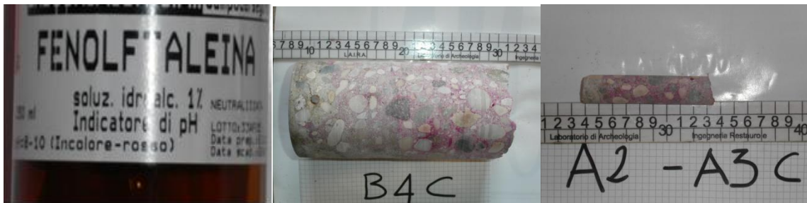
figura 1.141 – Prove di carbonatazione
