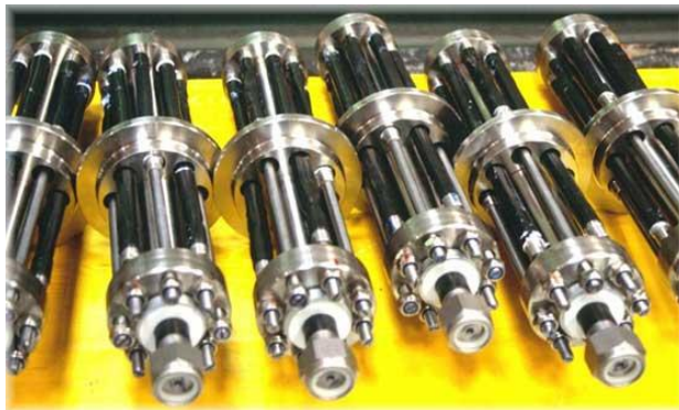
figura 23 – Dispositivi in lega a memoria di forma SMAD [4]
