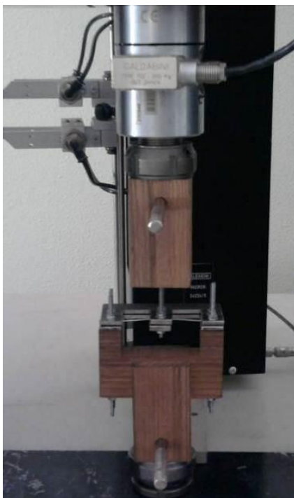
figura 2.98 - Test ciclici su filo di acciaio
