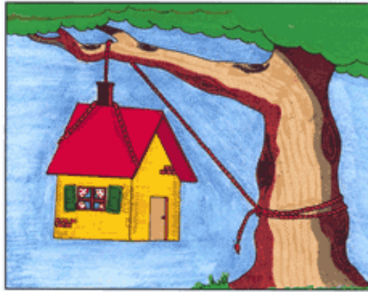
figura 2 – Idea alla base dell'isolamento sismico: disaccoppiamento del moto della struttura da quello del terreno
