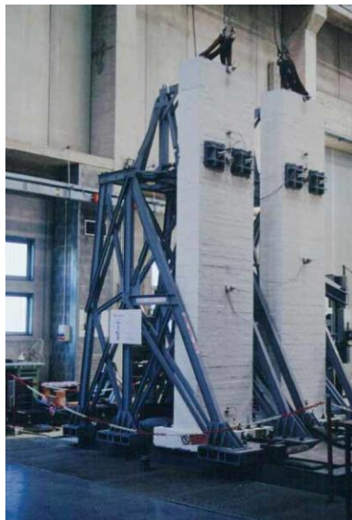
figura 64 – Tavola vibrante con i due muri in configurazione di prova [16]
