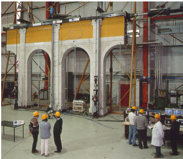
figura 24 – Modello in scala reale di un sotto-assemblaggio del monastero San Vicente de Fora [11]
