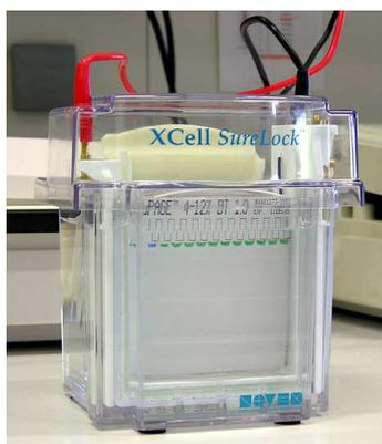
**Figura 20.** Apparato di elettroforesi su gel di poliacrilamide
