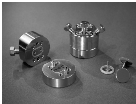
Figura 18. Micromixer in acciaio in grado di garantire elevato grado di mescolamento.
