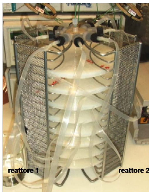
Figura 21. Reattore fluidico modulare costituito da singoli moduli indipendenti (reattore 1, reattore 2) collegati in parallelo a formare il reattore fluidico finale.
