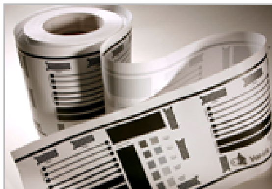
Figura 15. Esempio di stampa con inchiostro a base di grafene ossido ridotto (r-GO) disperso in solvente organico: La stampa risulta conduttiva.
