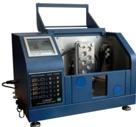
Figura 9. Il reattore Coflore® impiegato per gli esperimenti in flusso continuo. 14
