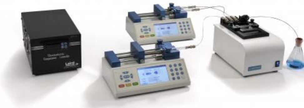
Figura 18. La piattaforma Labtrix®; in immagine si notano le due Syringe pumps e la cella pletier impiegata per riscaldare il reattore.
