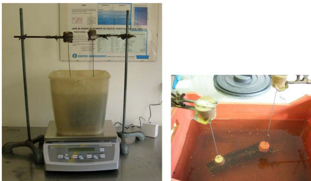
Figura 5: Immersione in acqua di una rotella e di un toppe per la determinazione del suo volume
