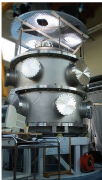
Figure A4.2. CESAM (Chambre Expérimentale de Simulation Atmosphérique Multiphasique)
